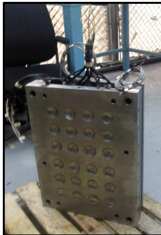
Figura 4.24 Ensamble final del sistema de inyección con las cavidades del molde
