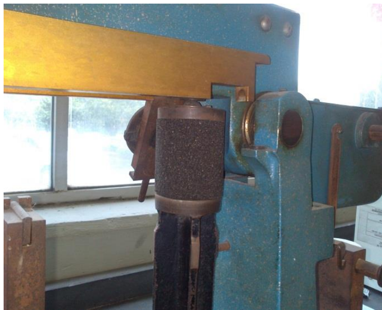
Fig.3.3 Compresión de una probeta tierra-latex con la máquina de esfuerzo para arenas.
