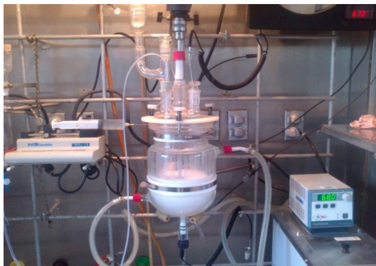
Fig 3.1 Esquema de reacción en emulsión en reactor semi-continuo.
