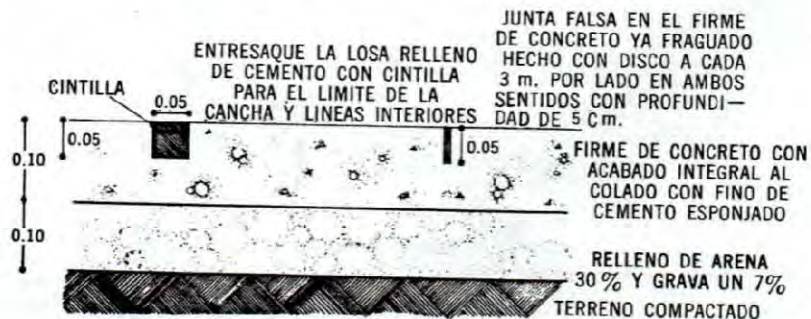
CANCHA DE CONCRETO CORTE
