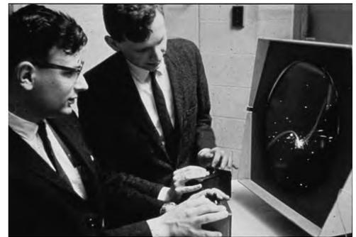
**Fotografía 64** Este equipo es la primera computadora producida en serie en 1960, y fue famosa por ser la computadora más importante en la creación de la cultura hacker en el MIT. Utilizó cinta de papel perforado como medio de almacenamiento, era diferente a las tarjetas perforadas.
