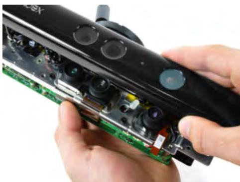
Fotografía 157 Elementos internos del sensor Kinect. Microsoft Kinect .Teardown [www.ifixt.com](http://www.ifixt.com)
