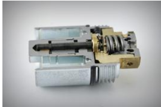
Figura 6.1.- La figura muestra la válvula de estrangulamiento de un amortiguador controlado electrónicamente
