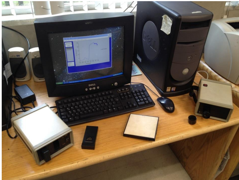
Figura 4-2. Equipo para la medición de la intensidad de radiación.
