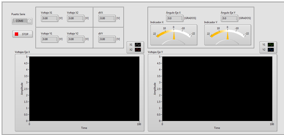
Figura 2-27. Panel frontal de la interfaz en LabVIEW.
