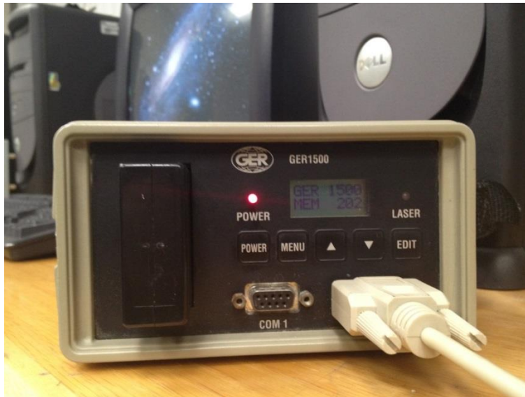
Figura A-4. Conexión serial del espectrómetro.
