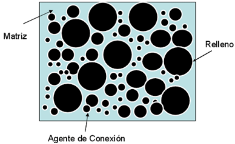
Figura 1 Componentes fundamentales de las resinas compuestas. 14
