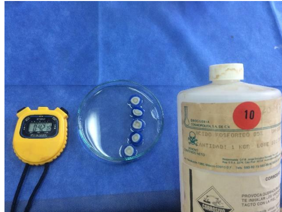
Figura 56 Grabado ácido de las muestras por ambas caras(ácido fosfórico 85%).
