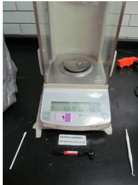
Figura 26 Pesado y dosificación de resina para realizar la muestra
