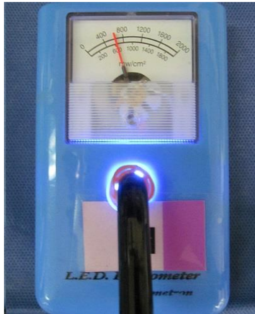
Figura 10 Medición de la intensidad lumínica de la lámpara con radiómetro ( mW/cm^2 )
