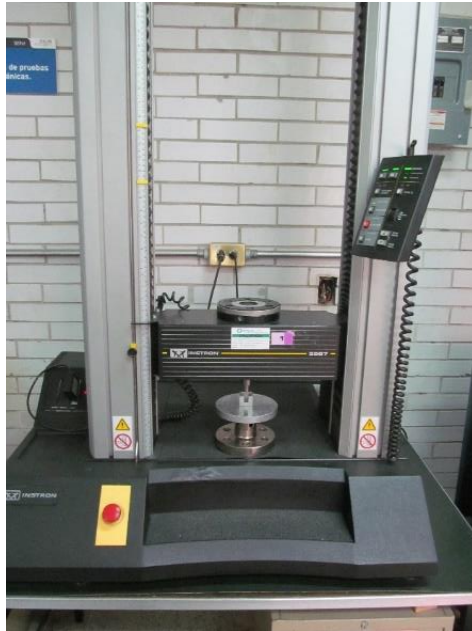
Figura 25 Máquina Instron preparada para realizar prueba de flexión de tres puntos
