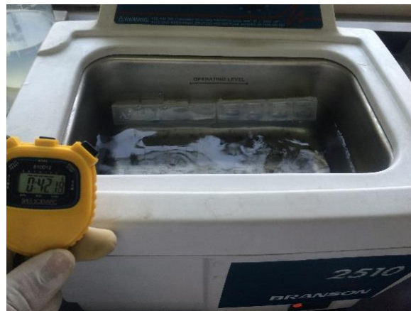
Figura 55 Lavado ultrasónico de las muestras para eliminar residuos de óxido de aluminio.
