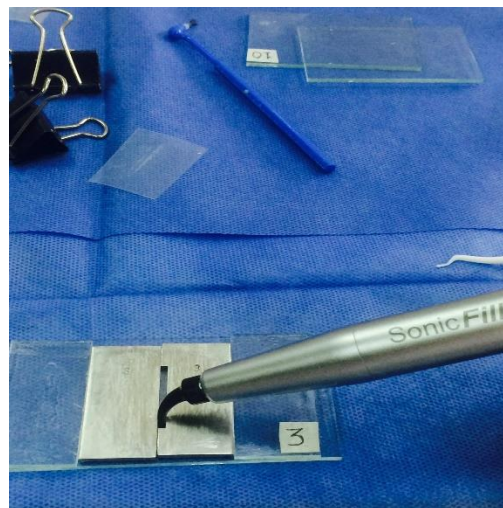
Figura 14 Llenado del molde con la resina Sonic Fill.
