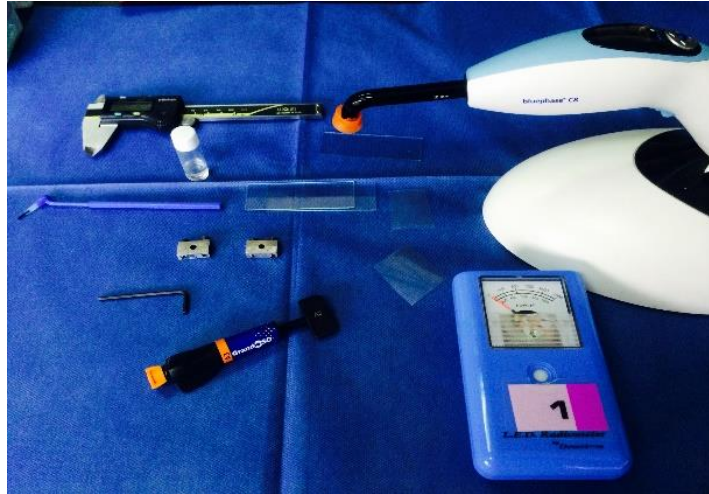
Figura 11 Material y equipo utilizado para la prueba de profundidad de curado.
