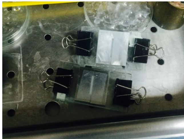
Figura 16 Muestras dentro estufa de temperatura controlada 37\pm 1 °C
