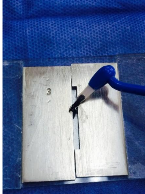
Figura 13 Se realiza colocación de aceite de silicón al molde para muestra de flexión.
