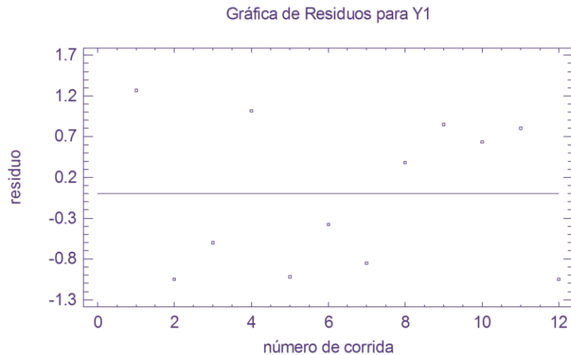
Gráfico 21: Gráfico de residuos vs número de corrida para comprobar el supuesto de independencia del ANOVA.
