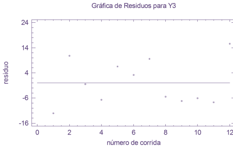
Gráfico 33: Gráfico de residuos vs número de corrida para comprobar el supuesto de independencia del ANOVA.
