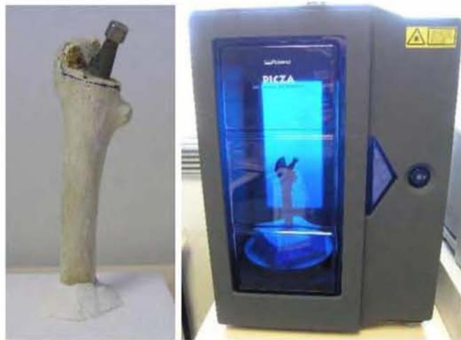
*Imagen 3.1. Ensamble implante-fémur y escaneado laser 3D. (García, 2012)*
