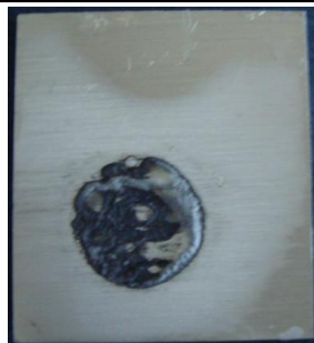
Figura 4.28. Placa A_CambX4_1s_spin después de ser sometida a delaminación catódica.
