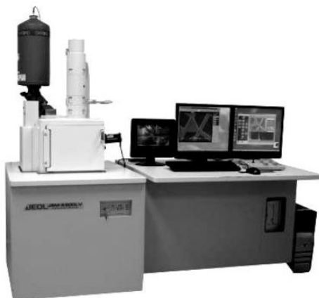
Figura 3.11. Equipo de SEM-EDAX utilizado en la USAI-FQ
