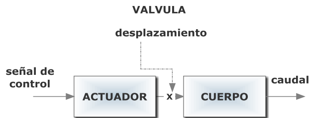
Figura 18. Representación en diagrama de bloques de una válvula de control.
