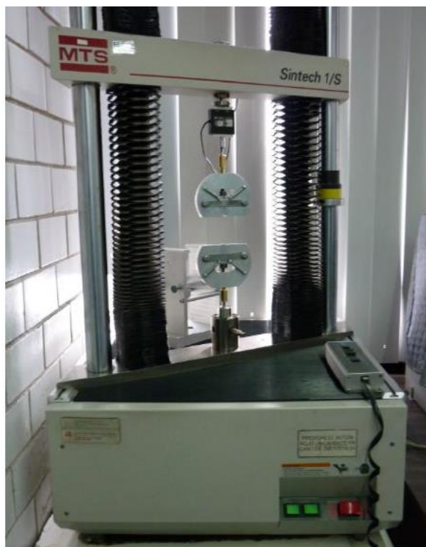
Figura 3. Máquina de pruebas mecánicas SINTECH 1/S.
