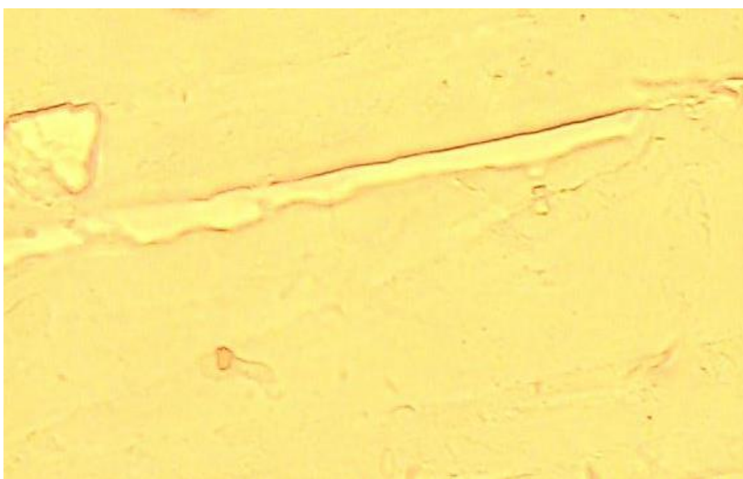
Figura 7. Microfotografía de una película de λ-carragenina y sorbitol secada a 87 °C. (Aumento 40x).
