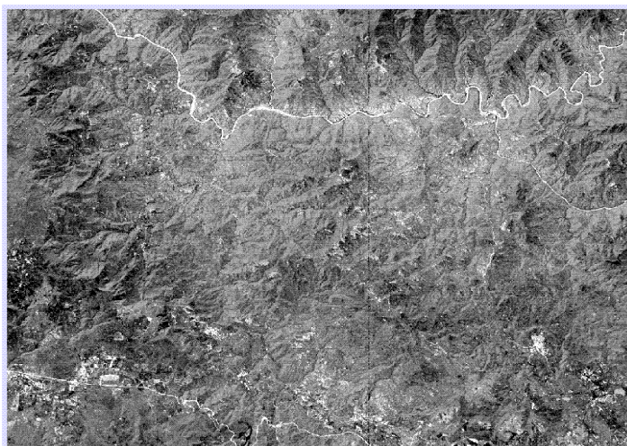
Figura 34.- Imagen de la componente principal 2 (CP2), los píxeles en tonos de color claro, corresponden a los óxidos de hierro presentes en el área de estudio.
