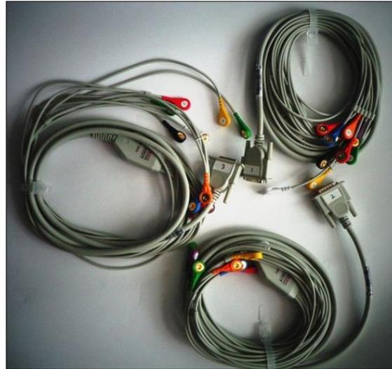
Figura 3.5 Cables de ECG de 10 derivaciones.
