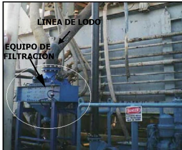
Fig. 2.9 Equipo de filtración siendo probado en superficie
