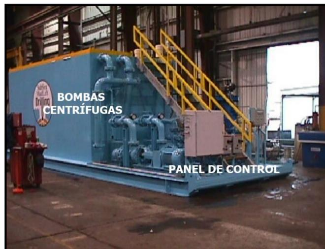
*Fig. 2.11 Unidad para filtración de agua de mar*
