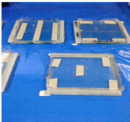
Figura 24. Parches transdérmicos en moldes de acetato sobre placa de vidrio.
