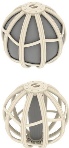
Funciona como una estructura exterior para la bolsa que contendrá el agua, permitiendo tener un referente visible de la cantidad de agua con la que se cuenta.
