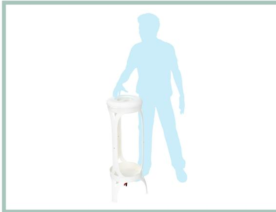
**1** Se coloca la estructura inferior tomándola con ambas manos de pie. Sosteniendo la estructura inferior con una mano, se coloca la estructura superior (incluye la tapa) con la otra, haciendo coincidir las columnas. Se debe ejercer presión desde la parte superior hasta que el ensamble entre por completo.
