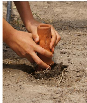
Figura 53. Introducción del difusor para la prueba 3 al suelo, usando ambas manos.
