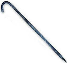
Las estacas de acero se encuentran de forma comercial, en este caso se usan las estacas de 24” por ½”
