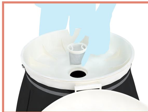
**2** Se retira el filtro tomándolo de sus abrazaderas interiores con los dedos índice y pulgar, una vez fuera se le da vuelta a la bolsa y se hace pasar agua a presión por la malla. Si esto no es suficiente se puede cepillar. Se regresa la bolsa a su posición original. Reintroduce el filtro y cierra la tapa.
