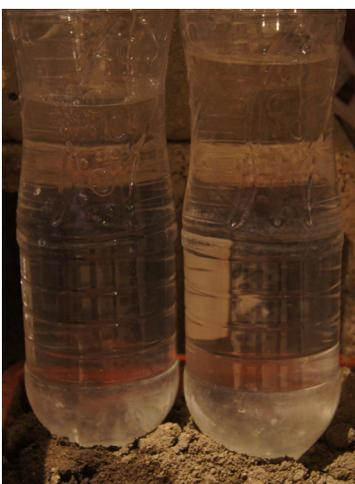
**Normal 2.** La cuarta prueba se realizó con suelo mixto. Debido a los resultados anteriores se retomó la medida inicial de 1250 ml. De la misma manera el suelo se encontraba semihúmedo y suelto. Durante esta prueba el difusor de barro (Figura 43) cedió 1025 ml., obteniendo un resultado más acorde con lo esperado. El difusor de cerámica cedió 45 ml. lo cuál fue mayor a la anterior ocasión.
