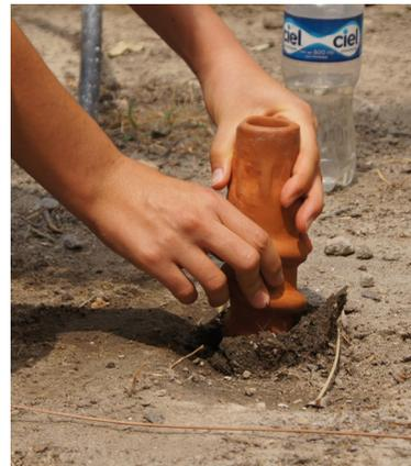
Figura 52. Introducción del difusor para la prueba 3 al suelo.
