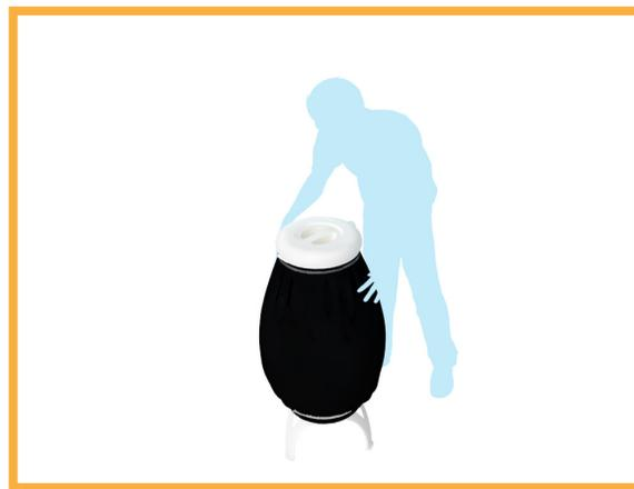
**2** Se coloca la nueva manga cortada a la medida (68 cm) y se sujeta con las abrazaderas bien apretadas.
