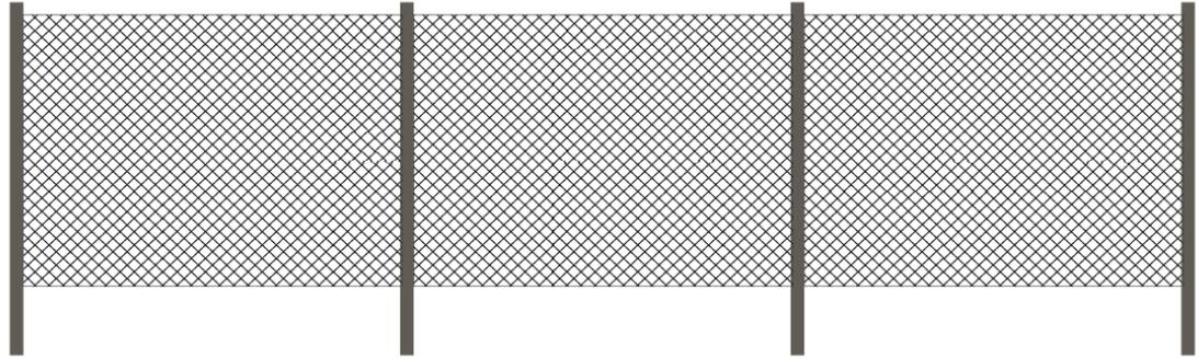
Las mallas regularmente son de 40 m<sup>2</sup>, con una altura de 4 a 8 metros. Una sola malla capta en promedio 200 litros al día, pero puede ir de los 150 a los 750 litros, dependiendo de las condiciones. Su acomodo se realiza con hasta 3 mallas continuas, dejando entre ellas unos metros para no impedir el paso del aire. (Figura 26)
