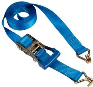
Las cintas de carga o eslingas de poliéster se encuentran de forma comercial. En este caso se usa la cinta con terminación de doble gancho o en J por la parte superior y con terminación de ojal reducido por la parte inferior que se une a la estaca. Su longitud para los tensores posteriores es de 6 m y para los frontales de 1 m, con un ancho de 2”.
