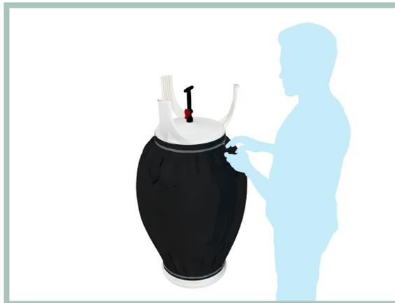
**4** Colocar la segunda abrazadera. Se debe jalar muy bien la manga para que ésta no cuelgue cuando se llene. Una vez a la altura correcta se coloca la abrazadera en el borde que indica su lugar y se ajusta con el tornillo.
