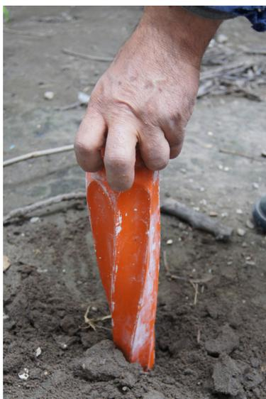
Figura 50. Introducción del difusor para prueba 2 al suelo.
