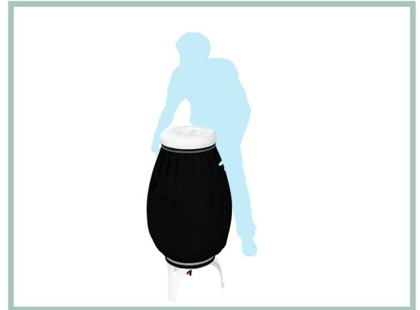
**2** Se coloca la manga de riego en el exterior de la estructura sosteniéndola con ambas manos. Primero por la parte superior se fija la manga a la estructura con la abrazadera. Uniendo el tornillo con la tuerca por medio de los dedos para fijar, posteriormente se ajustan con una llave hasta quedar bien apretado.
