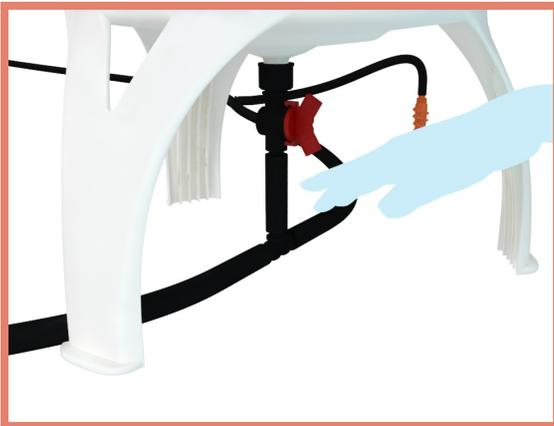
**C** En caso de ser necesario el uso de los depósitos para almacenar agua durante el periodo de lluvias. Se cierran las llaves de paso, desconectan todos los poliductos y de preferencia se retiran los difusores para su limpieza y almacenamiento.
