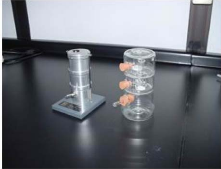
Figura. 24. Muestreadores en fase líquida con fraccionamiento de tamaño.
