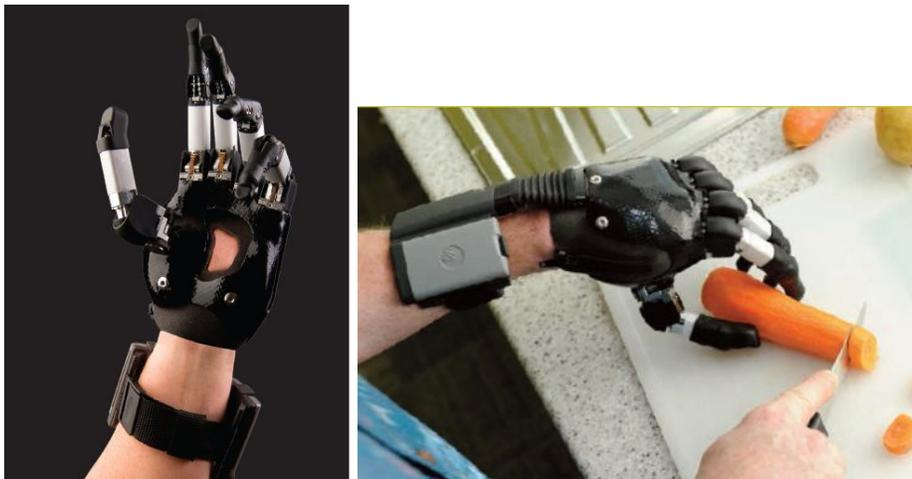
Fig. 36. Prensado de un objeto con i-limb digits. Fuente: [36].
