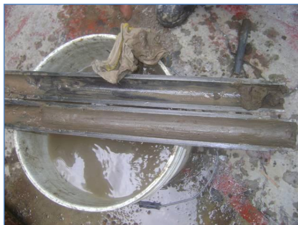
Foto 2.8 Vista de tubo partido
