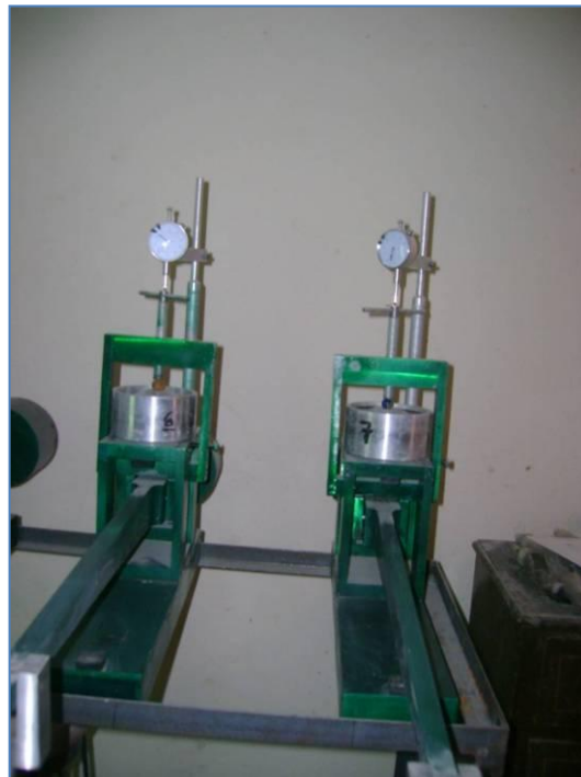
Foto 2.17 Prueba de consolidación
