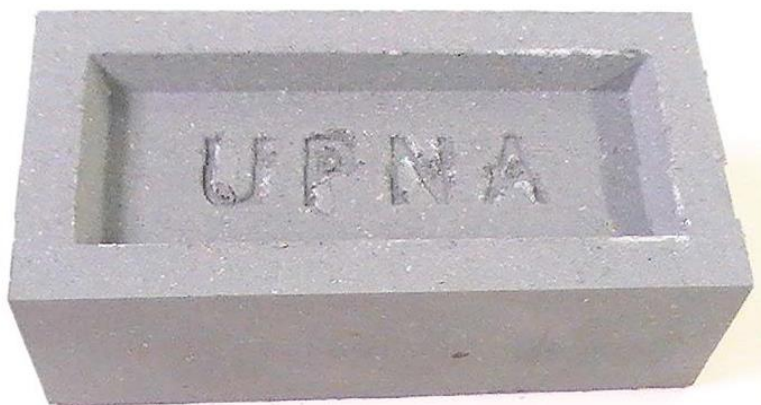
Figura 8. Ecoladrillo elaborado con materia orgánica cenizas y cáscaras de arroz Fuente: Cabo, 2011.
