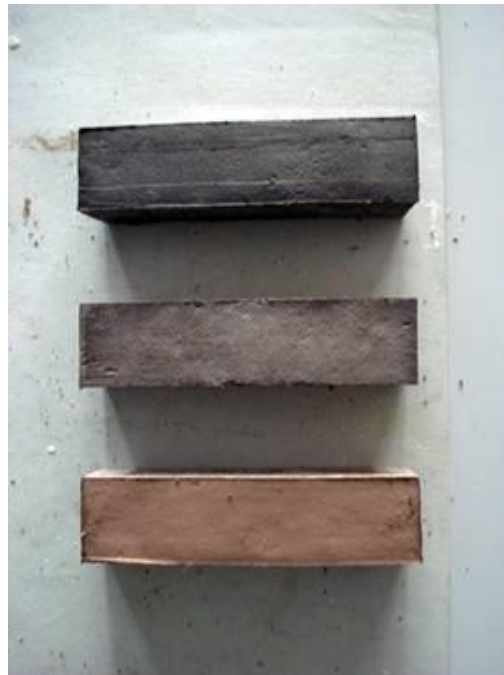
Figura 12. Ladrillos hechos con residuos de lana y algas marinas Fuente: Amorós, 2011.
