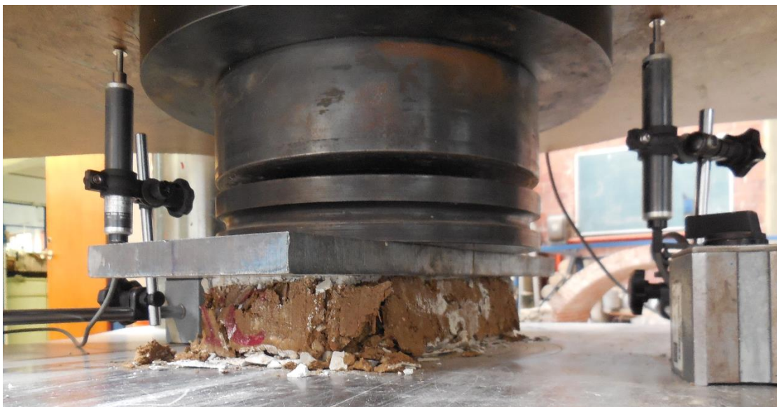
Figura 25. Ecoladrillo posterior al ensaye
