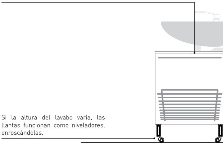
Si la altura del lavabo varía, las llantas funcionan como niveladores, enroscándolas.
