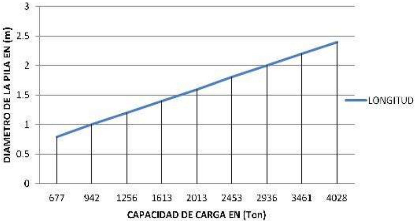
FIGURA 40 CAPACIDAD DE CARGA DE PILAS POR PUNTA Y FRICCIÓN DE 15 M DE LONGITUD EFECTIVA Y DESPLANTADAS A 40 M DE PROFUNDIDAD EN CONDICIONES ESTÁTICAS
