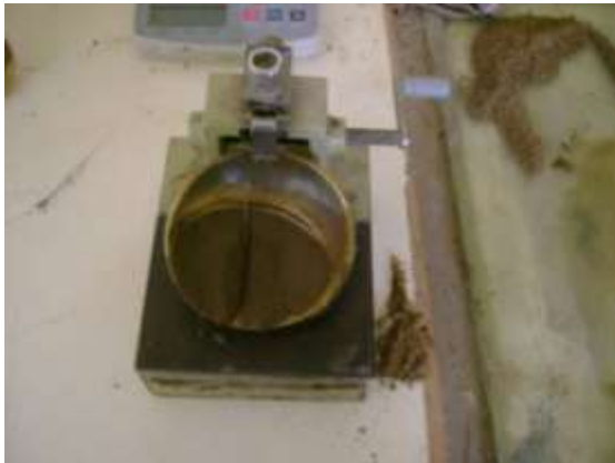
PRUEBA LIMITES DE CONSISTENCIA
