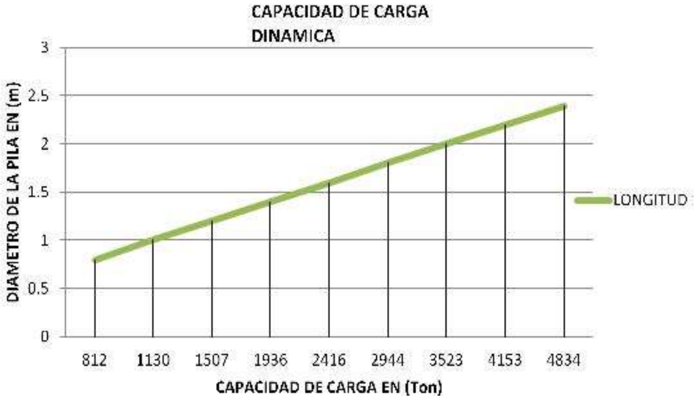
FIGURA 40 CAPACIDAD DE CARGA DE PILAS POR PUNTA Y FRICCIÓN DE 15 M DE LONGITUD EFECTIVA Y DESPLANTADAS A 40 M DE PROFUNDIDAD EN CONDICIONES DINÁMICAS
