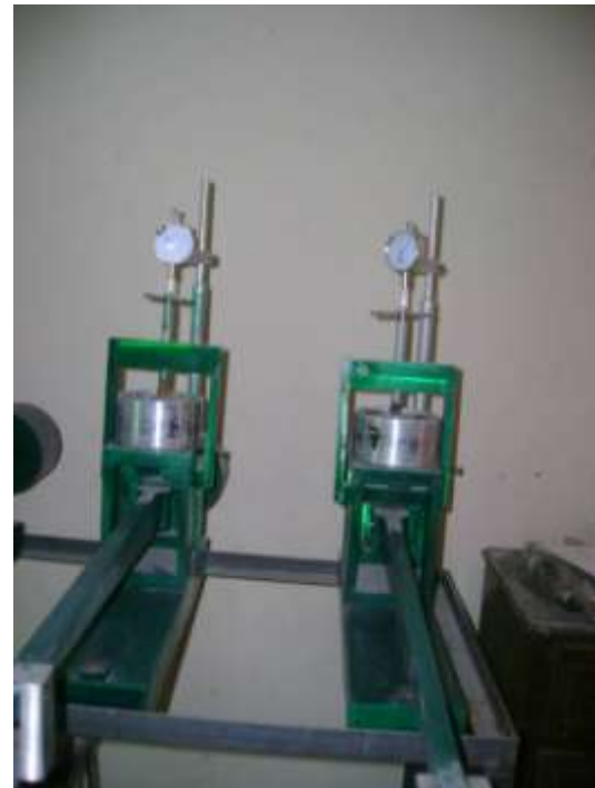
PRUEBA DE CONSOLIDACIÓN
