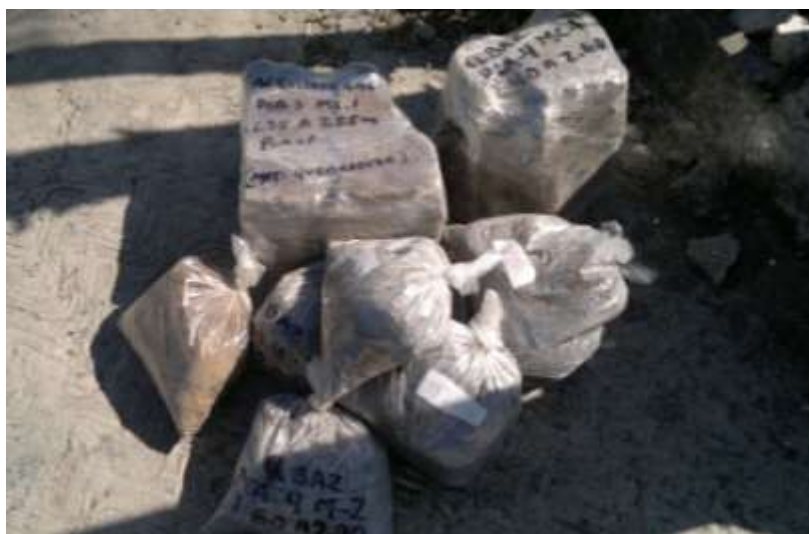
MUESTRAS CÚBICAS INALTERADAS EXTRAÍDAS DE LOS PCA'S.
