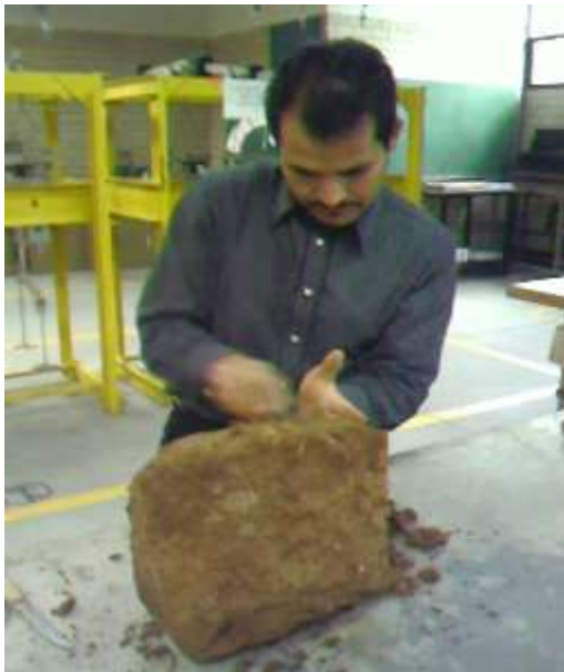
LABRADO DE MUESTRAS Y PRUEBA DE LIMITES DE CONSISTENCIA
