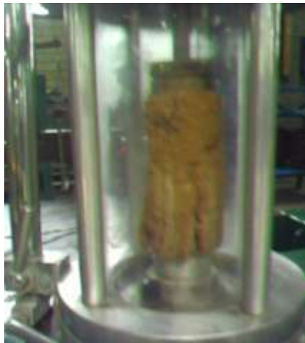
PRUEBA TRIAXIAL Y DE GRANULOMETRÍA
