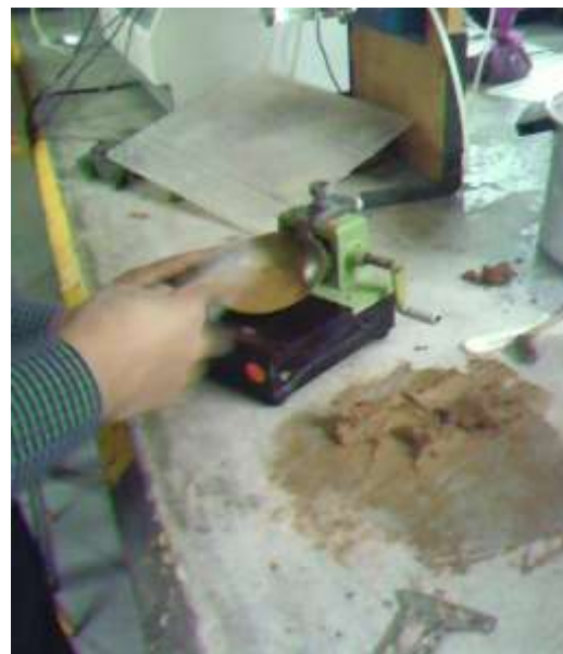
LABRADO DE MUESTRAS Y PRUEBA DE LIMITES DE CONSISTENCIA
