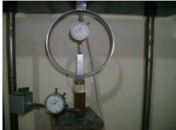
PRUEBA COMPRESIÓN SIMPLE
