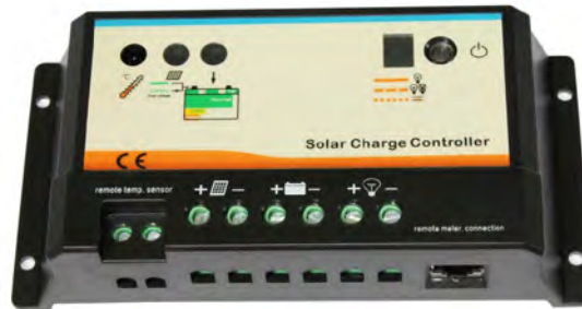
Figura 3.7: Controlador de carga.
