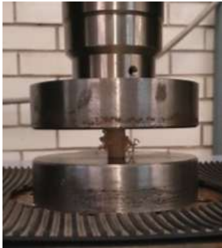
Figura 4.5 a) Gráfica esfuerzo-deformación de la probeta que falló con la precarga de 1000[N], b) y c) muestran la evolución de su deformación, se observa disminución de altura y cómo la medula ósea es expulsada del interior de la misma.
