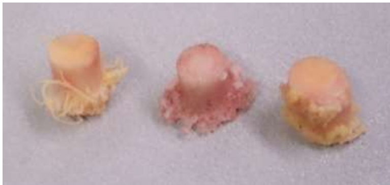
Figura 4.11 Aspecto final de las probetas que fatigaron tras ser sometidas a 700 ciclos de carga.
