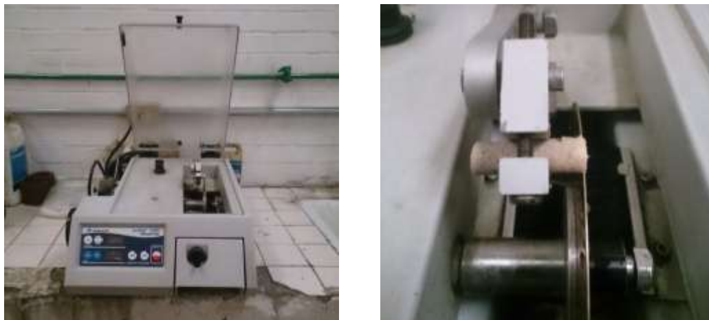
Figura 3.4 a) Cortadora de disco de diamante utilizada para el maquinado, b) debido a la manera en que sujeta las muestras, esta herramienta asegura que las caras de los extremos de las mismas, sean paralelas entre sí.
