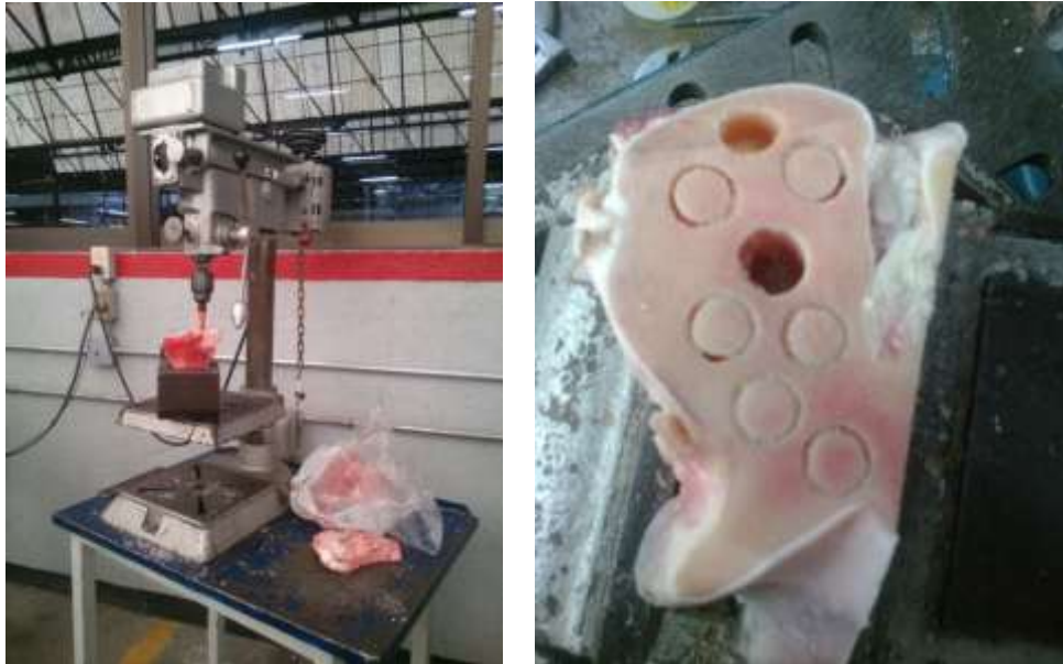
Figura 3.3 a) Se muestra la forma en la cual se extrajeron las muestras cilíndricas de hueso trabecular, se observa el taladro de banco, el sacabocados y la prensa sujetando al hueso, b) pieza ya maquinada, para este caso se extrajeron 6 probetas útiles, los dos agujeros son volúmenes incompletos y que son desperdicio al haber presentado fractura.
