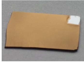
Figura 1.3. Recubrimiento de nitruro de Zirconio sobre silicio hecho para este trabajo.
