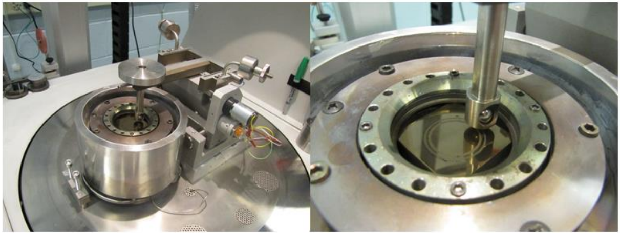
Figura 6.2. Prueba pin on disk sobre recubrimiento de TaN+Bi
