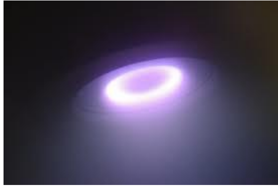
Figura 2.4. Plasma confinado por un magnetrón.
