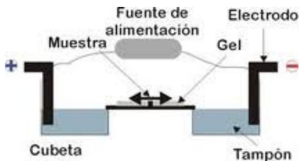
Figura 3.3 Electroforesis en gel. Los compuestos se separan de acuerdo al tamaño y carga al hacer pasar una corriente eléctrica a través del tamiz utilizado.
