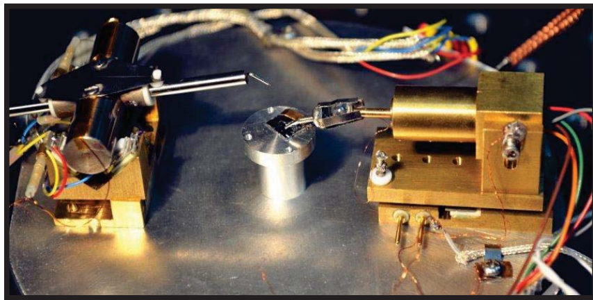
Figura 2.17. Estación con los dos manipuladores M1 (derecha) y M2 (izquierda). El portamuestra se encuentra en medio de los dos manipuladores.
