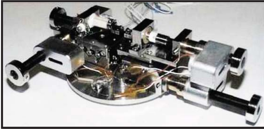
Figura 1.4. Manipulador para experimentos dentro del SEM fabricado por un grupo de la Universidad de Washington en colaboración con Zyvex. Utiliza cuatro tornillos de rosca fina (“picomotor”) accionados por cerámicas piezoeléctricas. [17]
