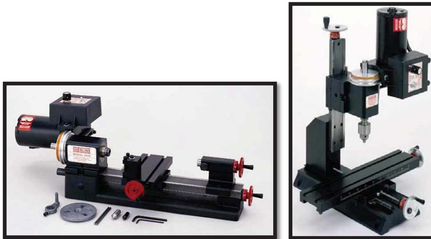
Figura 2.1 Torno y fresadora Sherline modelos 4000 y 5400 respectivamente, utilizados en el maquinado de piezas en este trabajo.
