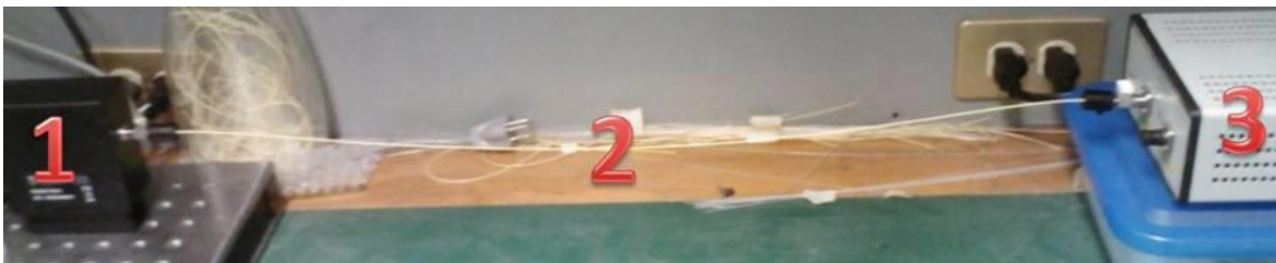
Figura 4.3-4.- Conexión de la fuente óptica de 1550 nm (3), la fibra óptica SMF 28 (2) y el sensor de la tercera ventana del infrarrojo del polarímetro (1)
