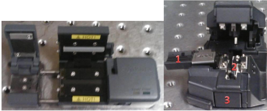
Figura 4.2-4.-Aparato para desnudar fibra óptica (a la izquierda) y cortadora de fibra óptica (a la derecha) adaptador de corte (1, disco de corte (2) y botón que recorre el disco de corte (3).
