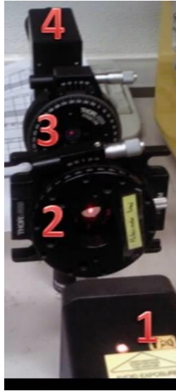
Figura 4.1-5.- Láser, polarizador, placa de \lambda/4 y sensor de luz visible
