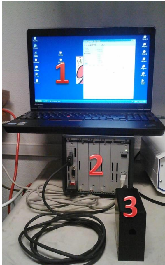
Figura 7.1-3.-Instalación completa del polarímetro. Computadora (1), polarímetro (2) y sensor (3)
