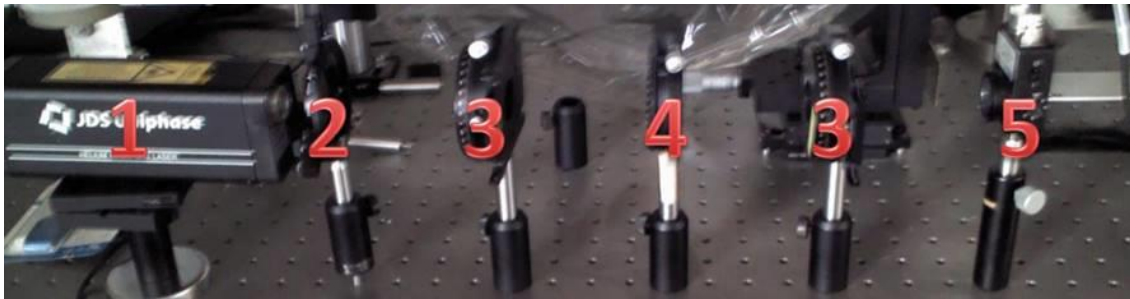
Figura 4.1-8.- Instalación usada para medir los parámetros de Stokes. Láser (1), placa muestra (2), polarizador (3), placa retardadora de \lambda/4 (4) y fotodiodo (5)
