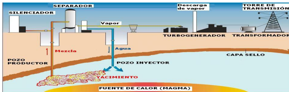
Fig. 1. Modelo esquemático de un yacimiento geotérmico.
