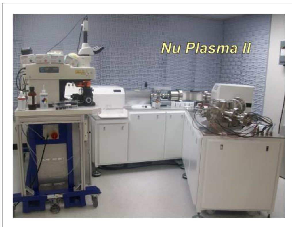
Figura 56. Instrumentación del Nu Plasma II HR MC-ICP-MS empleado en el Arizona Laser Chron Center para la fechamientos mediante U-Pb.
