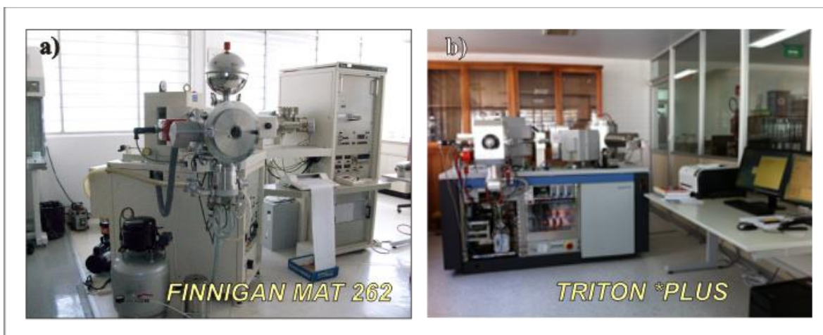
Figura 54. Espectrómetros de masas empleados en el Laboratorio Universitario de Geoquímica Isotópica, Instituto de Geofísica, UNAM: a) FINNIGAN MAT 262 y b) TRITON *PLUS .
