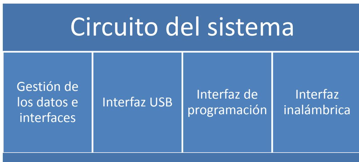
Figura 6.1.- Diagrama de bloques del circuito del sistema.
