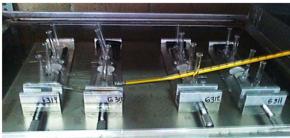
Figura 13. Sistema de liberación in vitro utilizando celdas de Franz.
