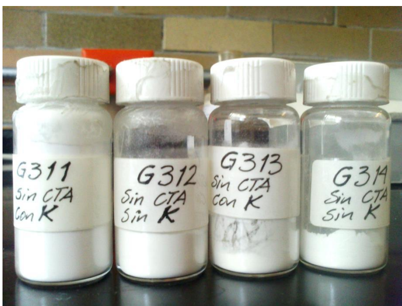
Figura 11. Hidrogeles poli (HEMA-co-EGDMA) con estructura no controlada empleados para este estudio.
