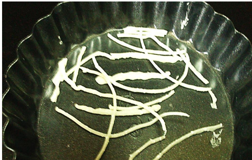
Figura 14. Implantes de hidrogeles poli (HEMA-co-EGDMA) cargados de Ciprofloxacino.
