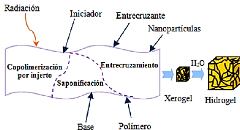
Figura 5. Componentes para la obtención de un hidrogel.
