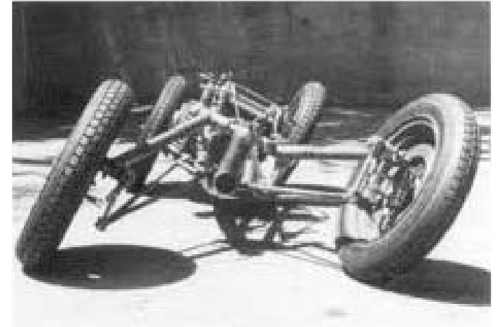
Dirección/Suspensión de un Messerschmitt KR175
