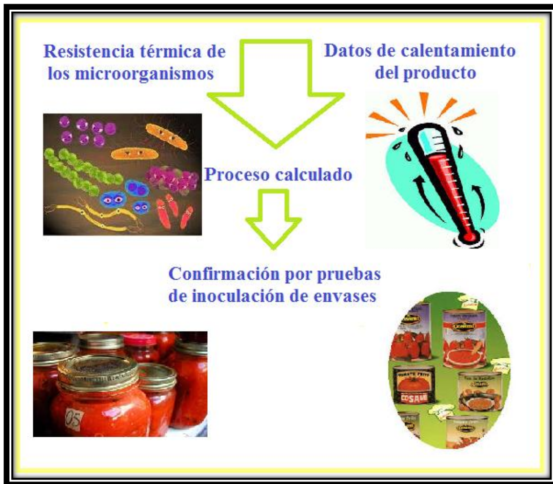
Figura 4. Diagrama de los pasos empleados en la determinación de un tratamiento térmico.
