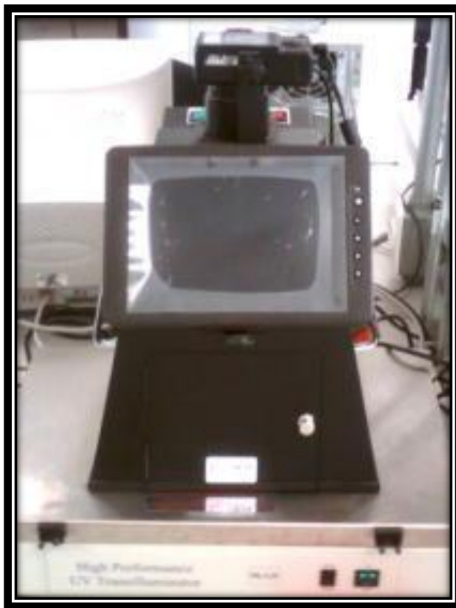
Figura 20. Cámara fotográfica y transluminador
