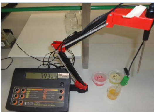
Figura 9. Evaluación de pH en potenciómetro Hanna Instruments.
