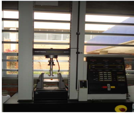
Figura 12. Determinación de firmeza de cubos de mango.
