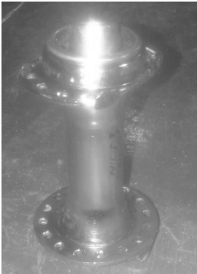
*Figura 3.8 - Masa de bicicleta - Rodamiento*
