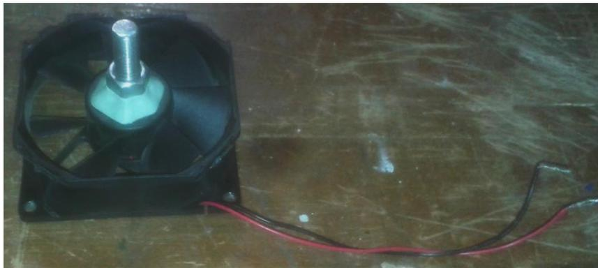
Figura 4.4 - Ventilador/Generador con sistema de acoplamiento
