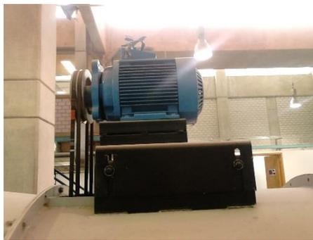
Figura 3.1 - Motor del túnel de viento
