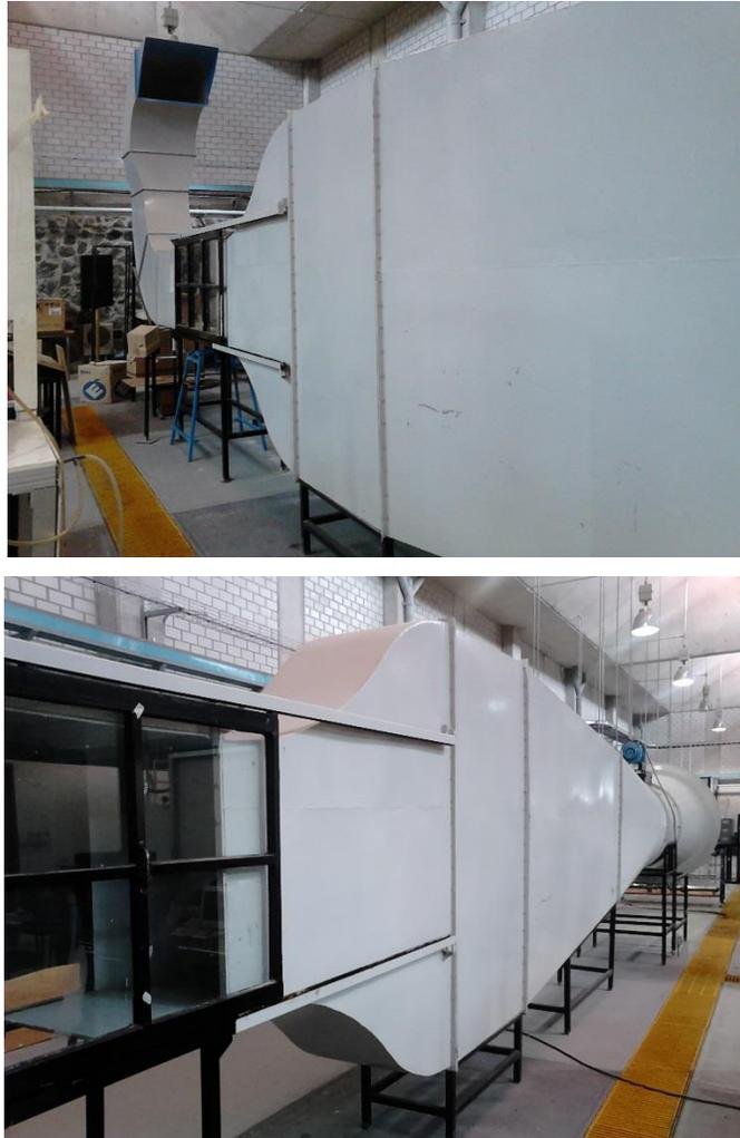
*Figura 3.4 - Túnel de viento*
