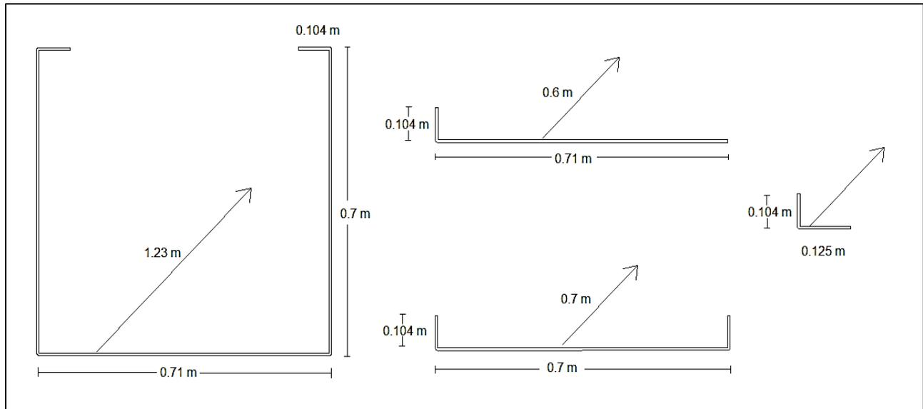
**Figura 4.7 Diagramas de láminas para construcción de incinerador del caso de estudio**
