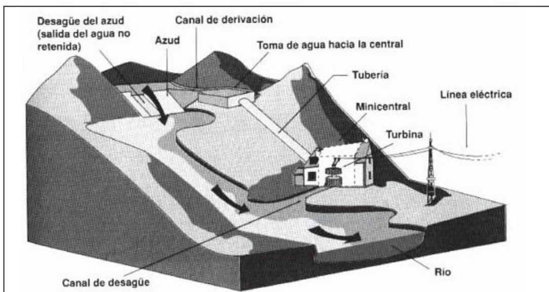
Figura 1.4 Esquema de aprovechamiento en derivación (Castells y Alsina, 2012)
