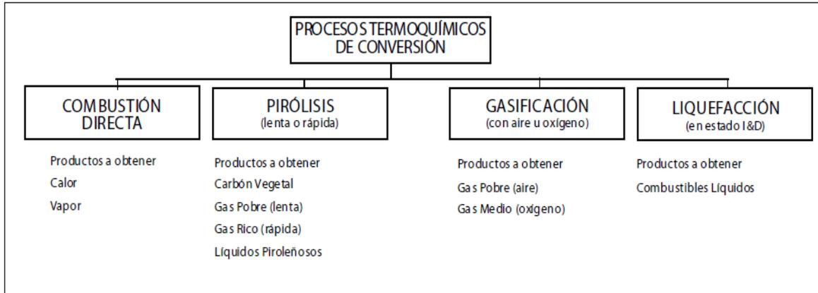
**Figura 2.15 Procesos de transformación de la biomasa en energía (INTI, 2008)**
