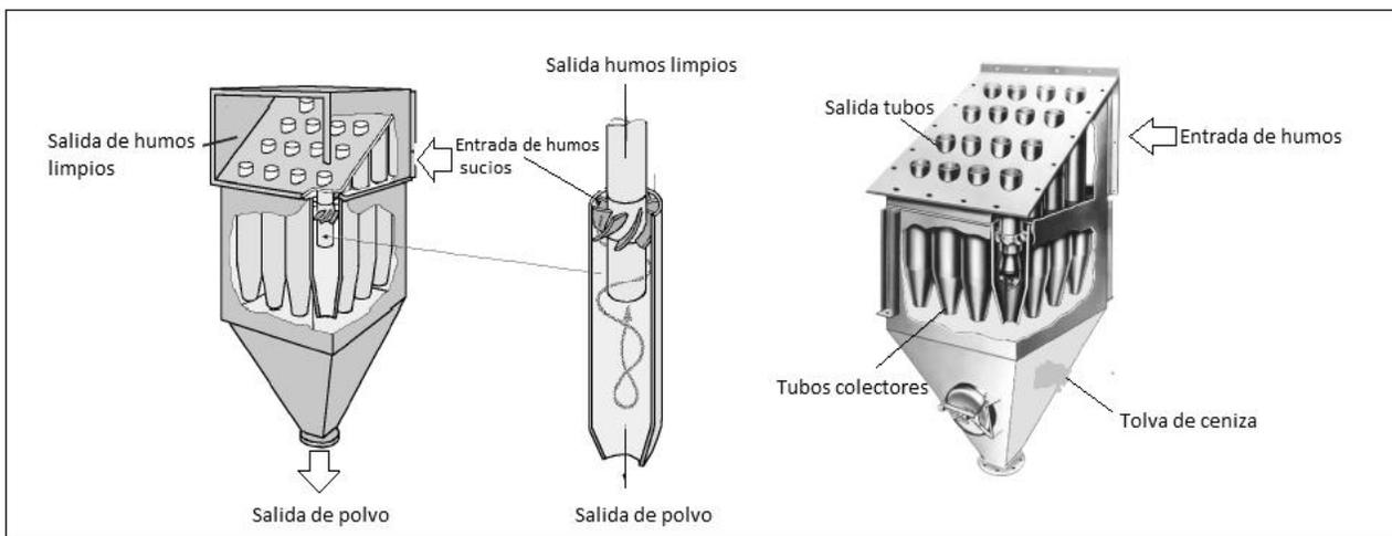
**Figura 2.34 Partes de un colector mecánico (Fernández, 2009)**
