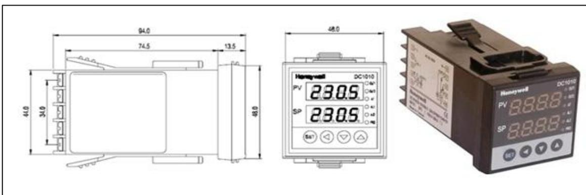
**Figura 4.21 Diagrama y fotografía de pirómetro Honeywell DC1010 que se instalados en el tablero de control**
