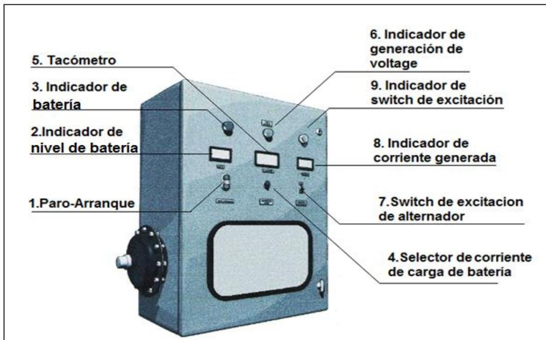
Figura 4.28 Tablero de control respecto al funcionamiento de la turbina
