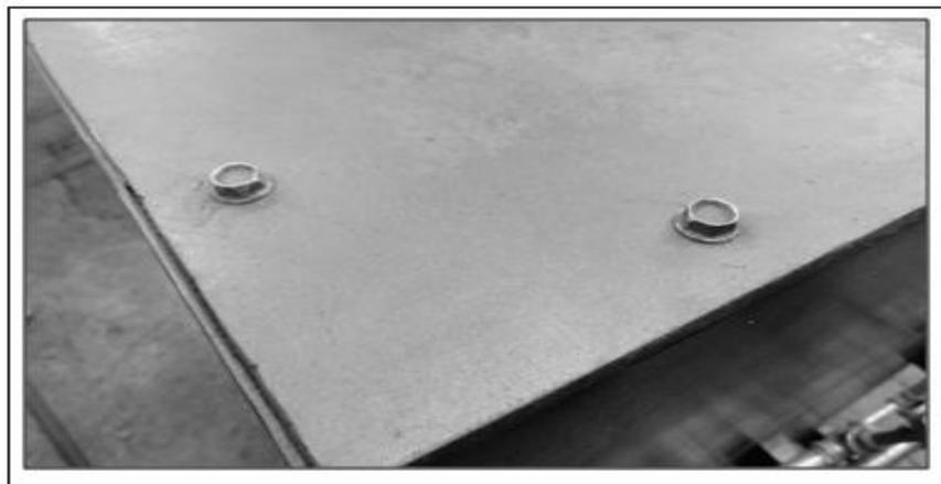
**Figura 4.11 Tornillos autorroscables para sujeción de tapa superior del horno del caso de estudio**
