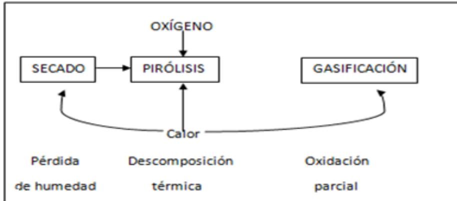
Figura 2.16 Etapas del proceso de gasificación de residuos (Castells, 2005)
