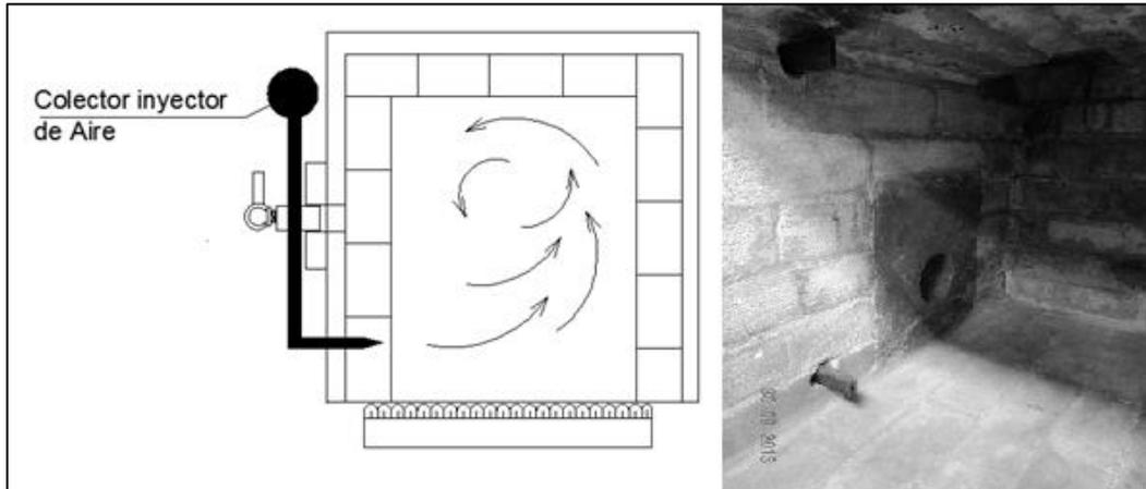
**Figura 4.15 Vista exterior e interior de la inyección de aire desde el colector implementado en el prototipo del caso de estudio**
