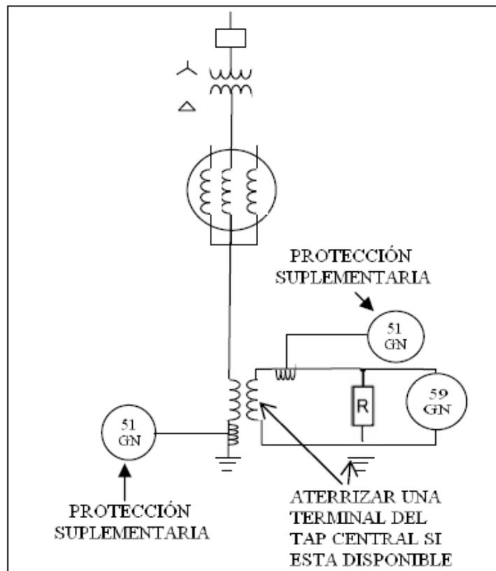
**Figura 2.44 Protección de voltaje de secuencia cero (IEEE, 2003)**
