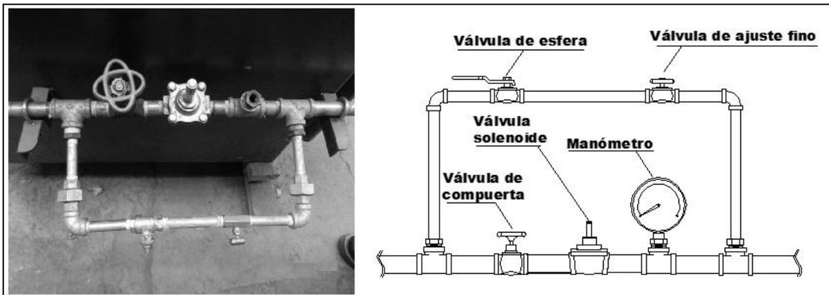
**Figura 4.14** Esquema de tren de válvulas para la inyección de gas lp para el caso de estudio
