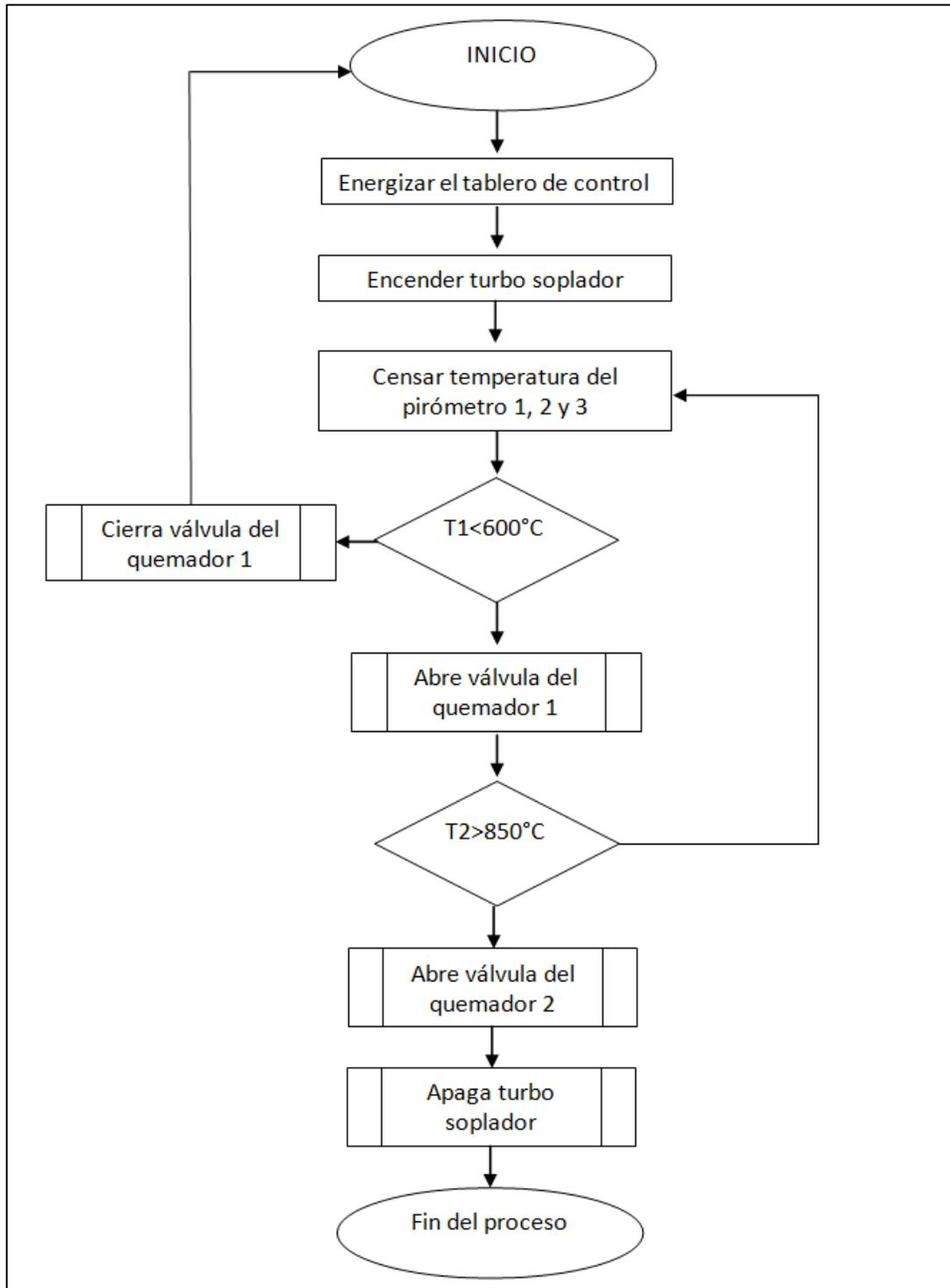
Figura 4.23 Diagrama de flujo del proceso de operación del incinerador
