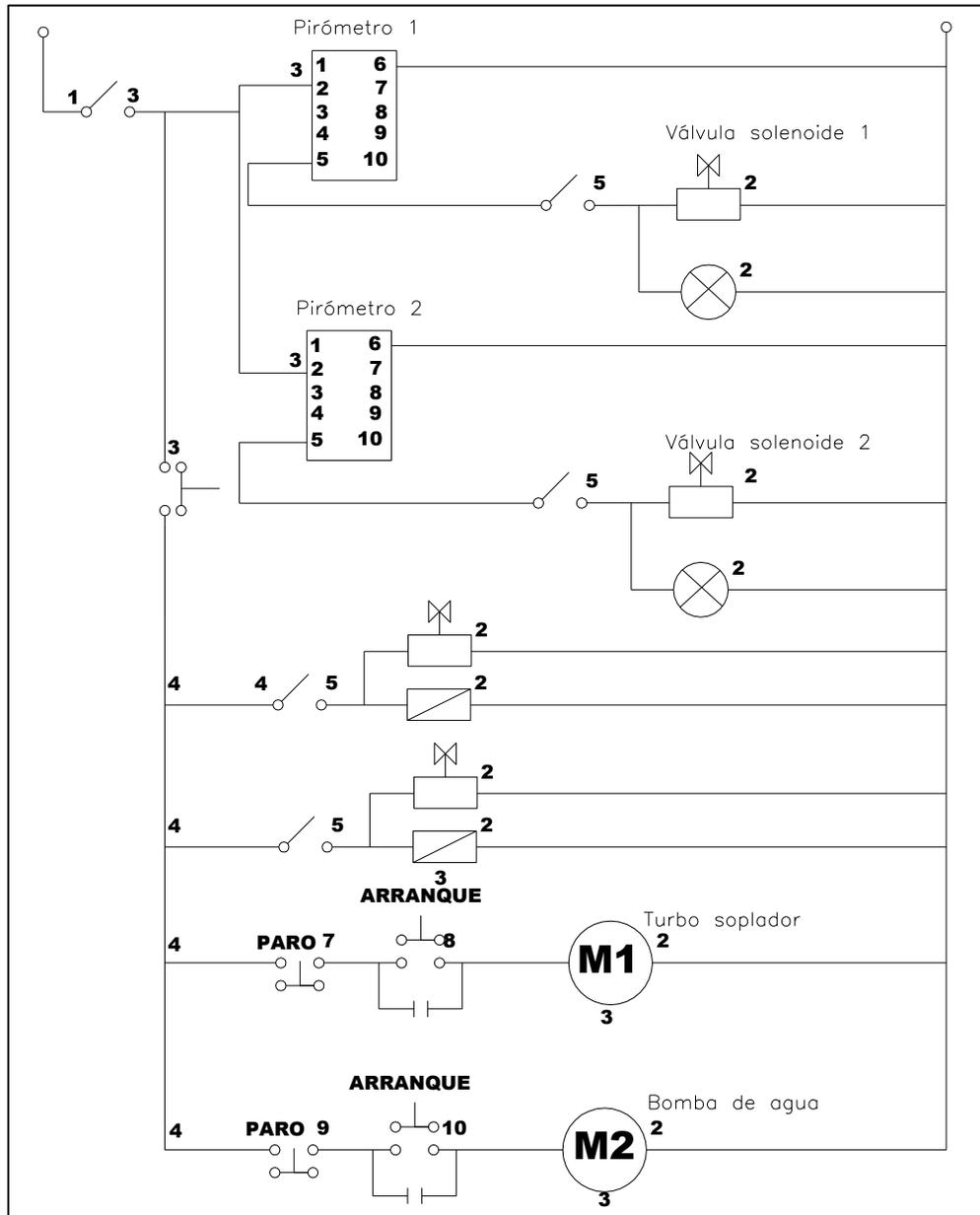
Figura 4.22 Diagrama eléctrico respecto al control de incinerador, turbo ventilador y bomba de agua
