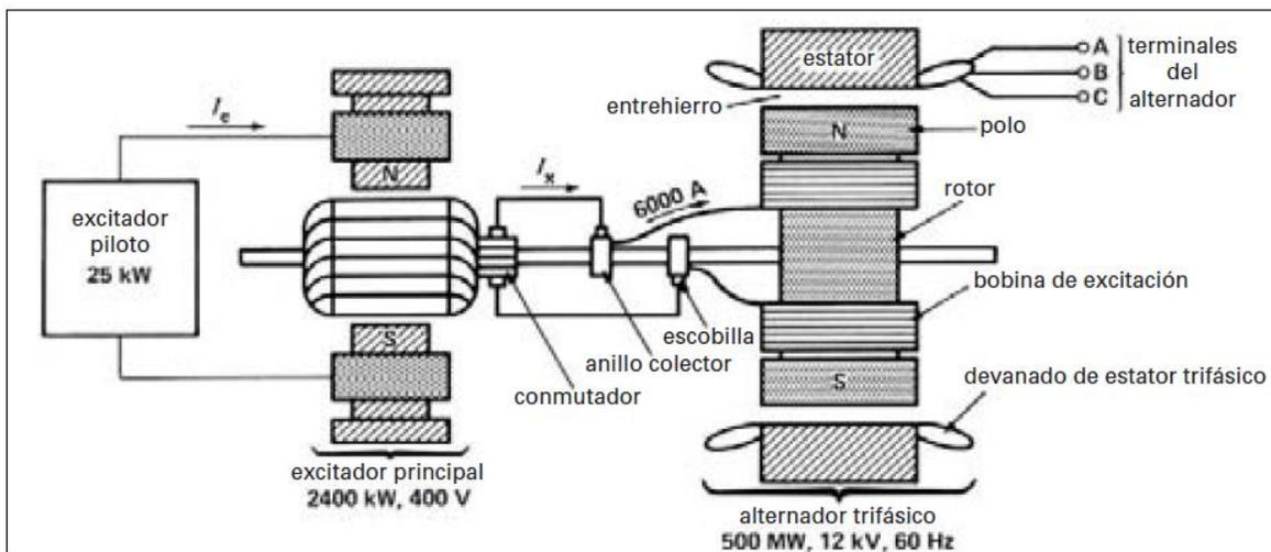
**Figura 2.41 Diagrama esquemático y vista de corte transversal de un generador síncrono de 500 MW típico y excitador de dc de 2,400 kW (Wildi, 2007)**
