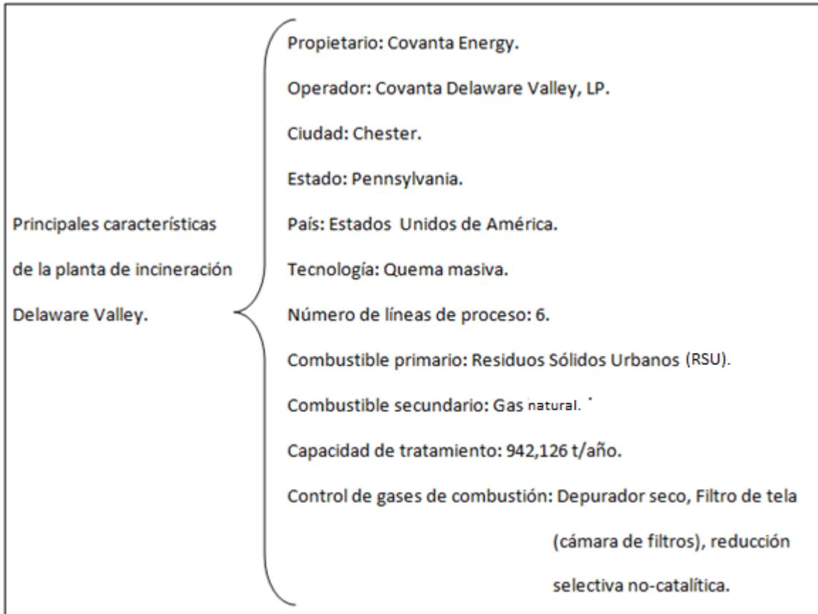
**Figura 2.20 Características de la planta de incineración Delaware Valley en EE. UU (COVANTA, 2013)**
