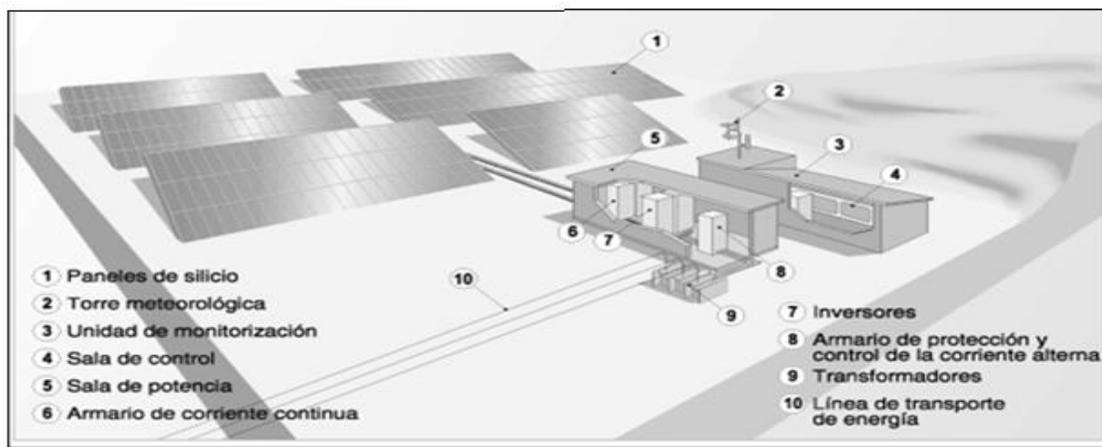
Figura 1.8 Diagrama de central fotovoltaica (UNESA, 2011)
