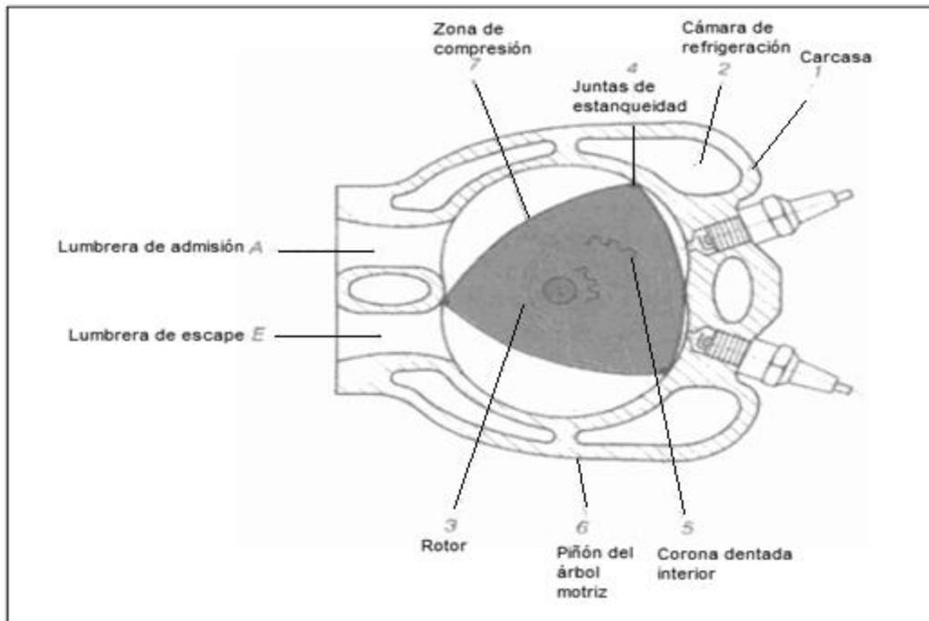
**Figura 2.2 Sección esquemática de un motor de émbolo rotativo (CEAC, 2004)**
