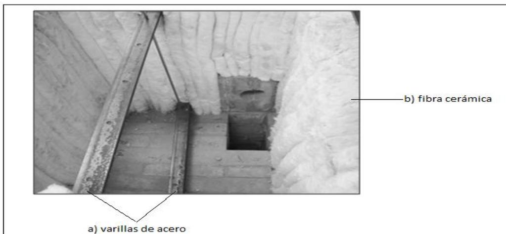
**Figura 4.13 Vista superior del horno con recubrimiento de fibra cerámica**
