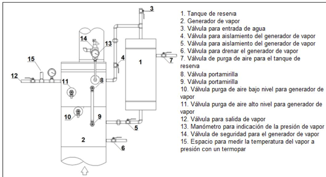
**Figura 3.4 Configuración del equipo de generación de vapor del caso de estudio**
