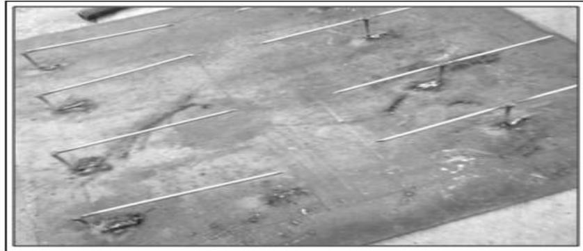
**Figura 4.12 Tapa de cámara secundaria con anclas de acero inoxidable para soporte de fibra cerámica en la parte superior del incinerador prototipo**
