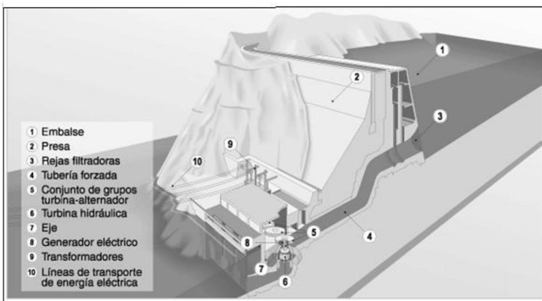
Figura 1.5 Diagrama de central hidroeléctrica (UNESA, 2011)
