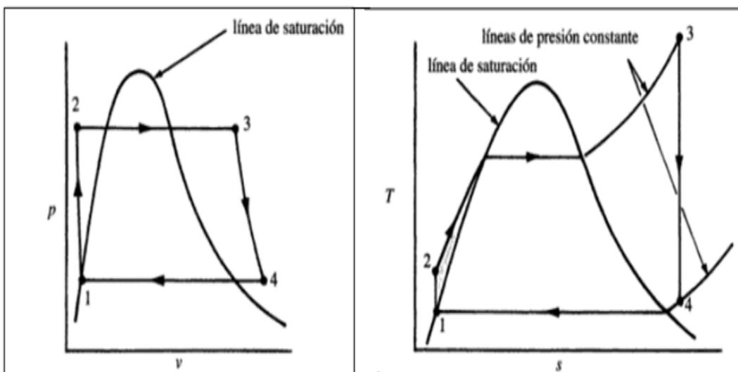
**Figura 2.9 Diagramas de presión-volumen y Temperatura-entropía ciclo Rankine (Rolle, 2006)**
