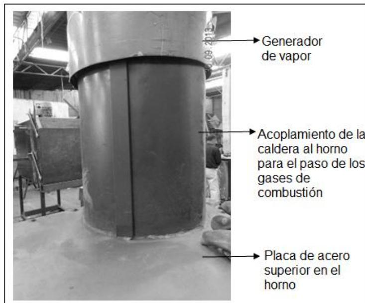
**Figura 4.18 Fotografía del acoplamiento del horno al generador de vapor del caso de estudio**
