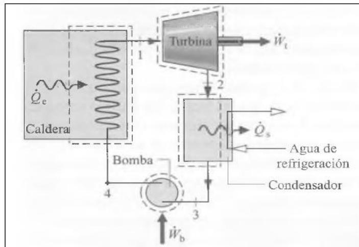
Figura 2.11 Principales transferencias de calor de una central térmica (Morán y Shapiro, 2005)
