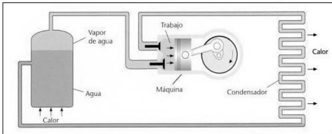
Figura 2.3 Esquema de una máquina de vapor (Tipler y Gene, 2006)
