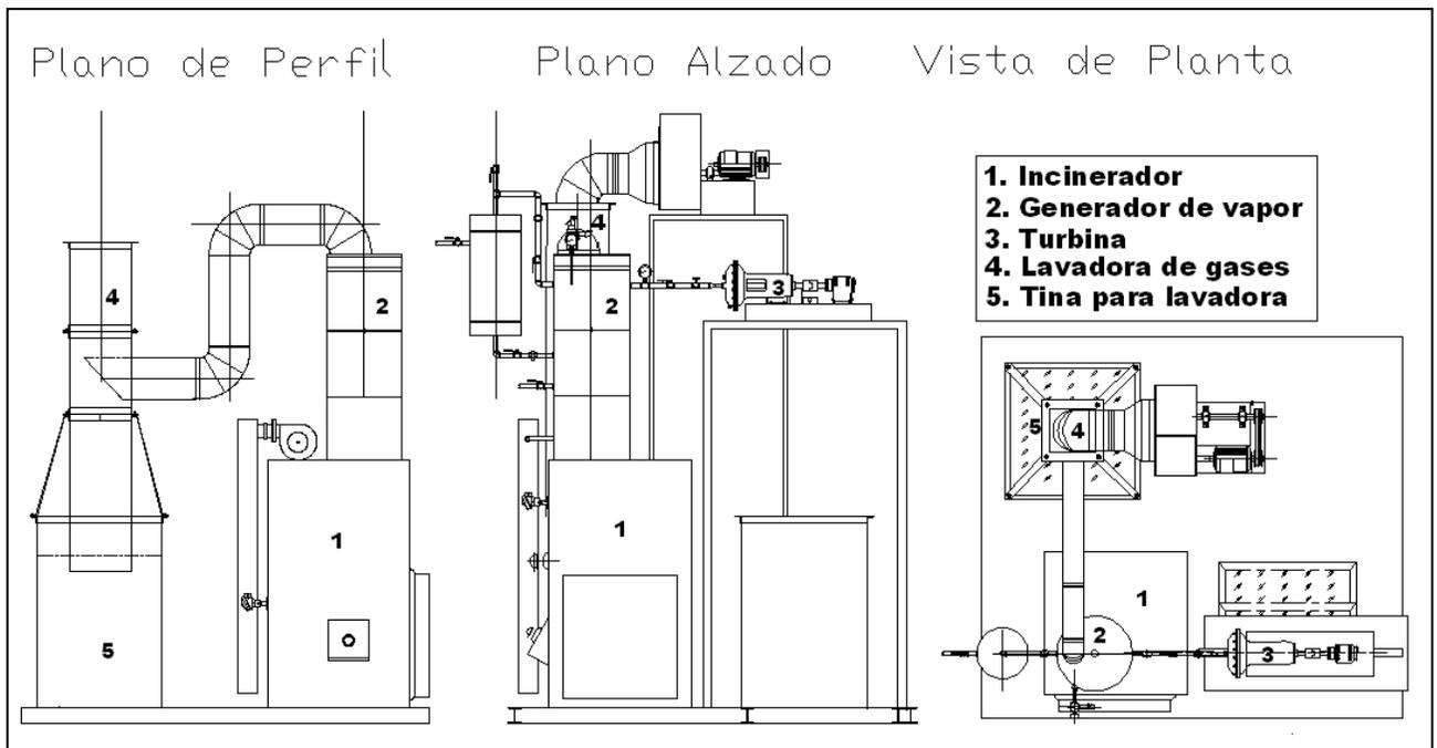
**Figura 4.2 Diseño general de prototipo con todos sus componentes**
