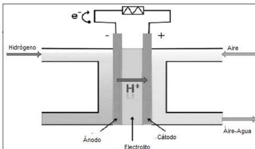
**Figura 1.9 Esquema del funcionamiento de una pila de hidrógeno (CNH2, 2013)**
