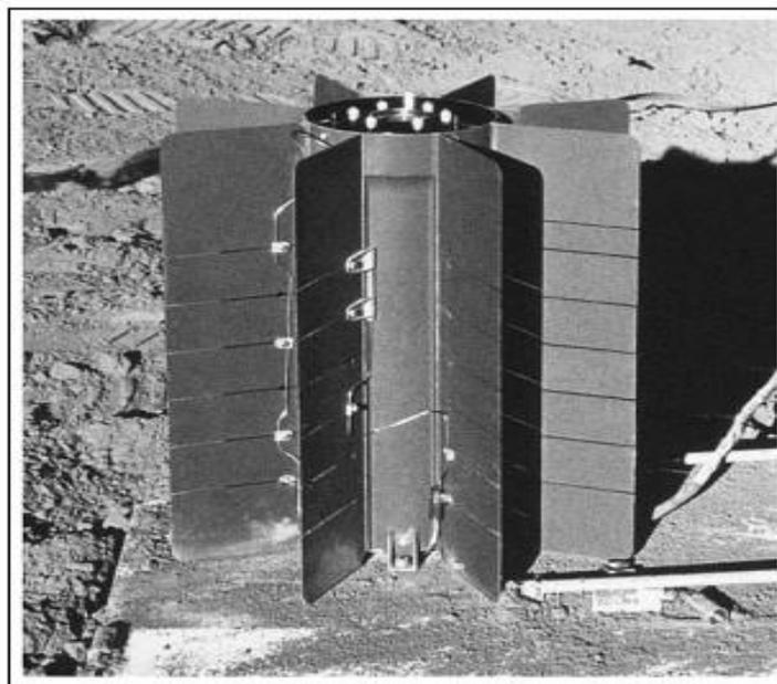
**Figura 1.10 Generador termoelectrónico de radioisótopos modelo SNAP-27 utilizado en la misión espacial Apollo 12 (Rowe, 2006)**
