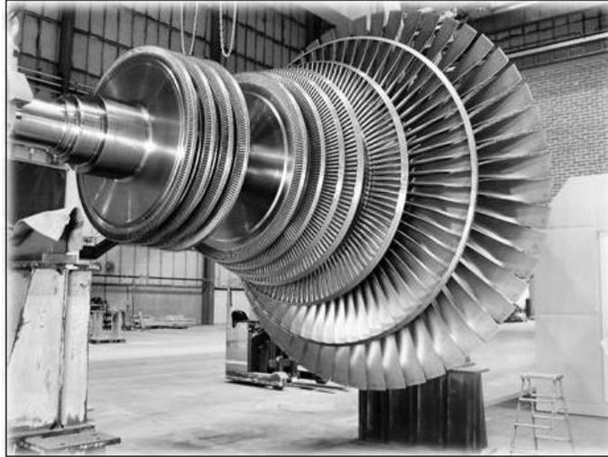
**Figura 2.13 Turbina de vapor (RENOVETEC, 2013)**
