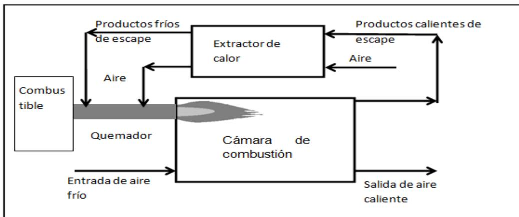
Figura 4.1 Esquema de los componentes en un sistema de combustión (Baukal, 2000)
