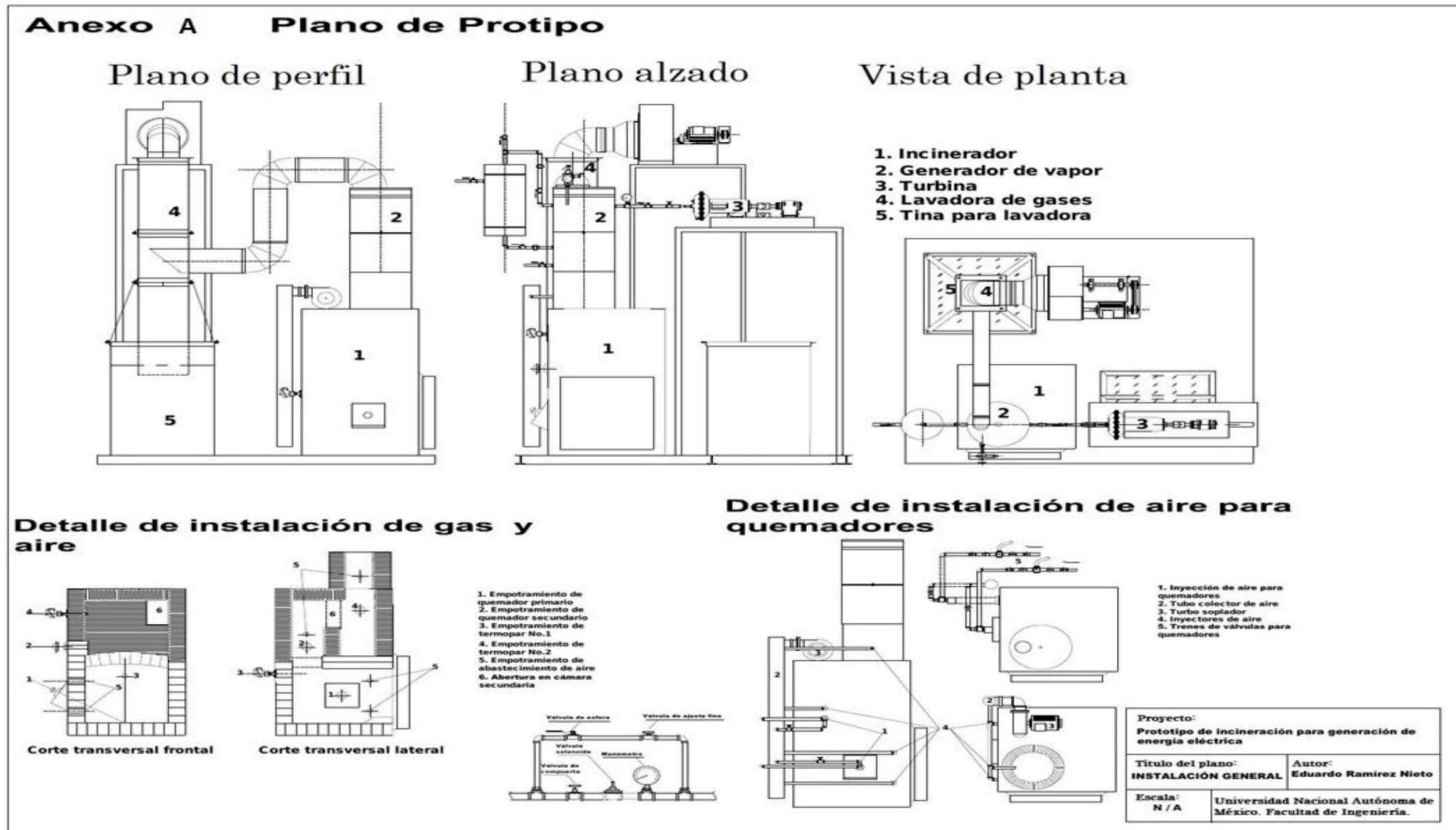
Figura A.1 Plano de la configuración general del prototipo de incineración del caso de estudio
