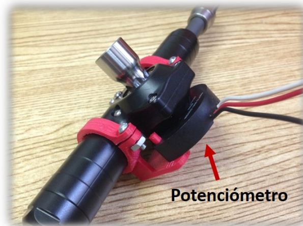
Figura 3.4: Potenciómetro para medir ángulo del volante.
