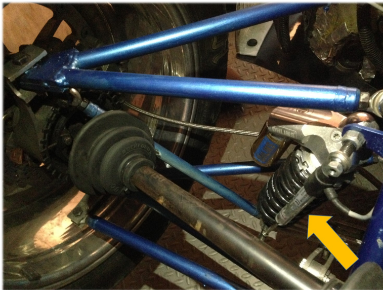
Figura 3.6: Montaje físico del potenciómetro lineal en la suspensión trasera.
