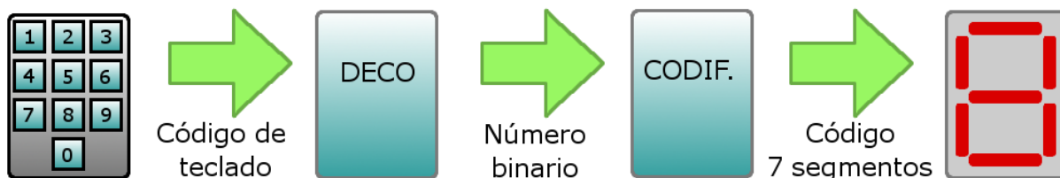
Figura 9: Ejemplo de sistema digital por bloques
