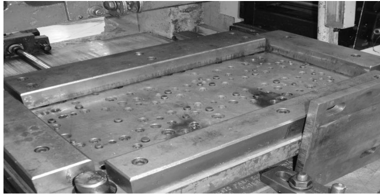
Fig. 20. Reposicionando los pernos botadores en el troquel se lograron obtener juntas con espesor uniforme.
