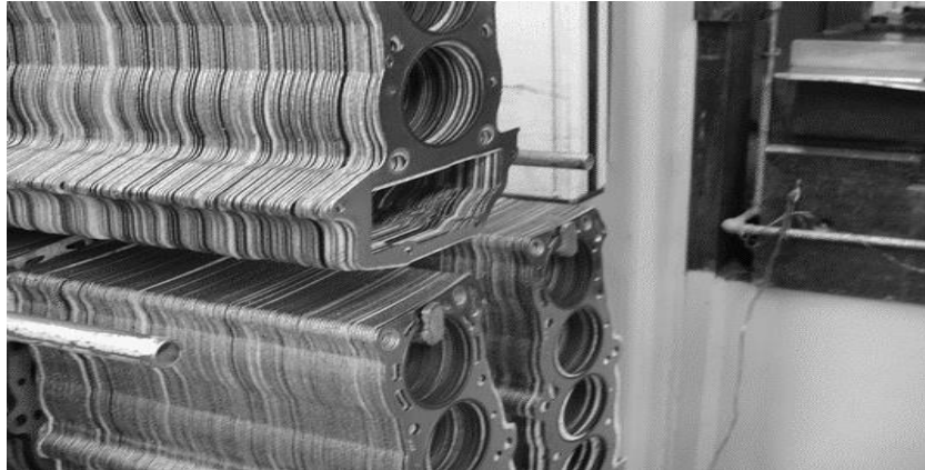
Fig. 17. Juntas dispuestas en el carro de recolección con separación de cartulina
