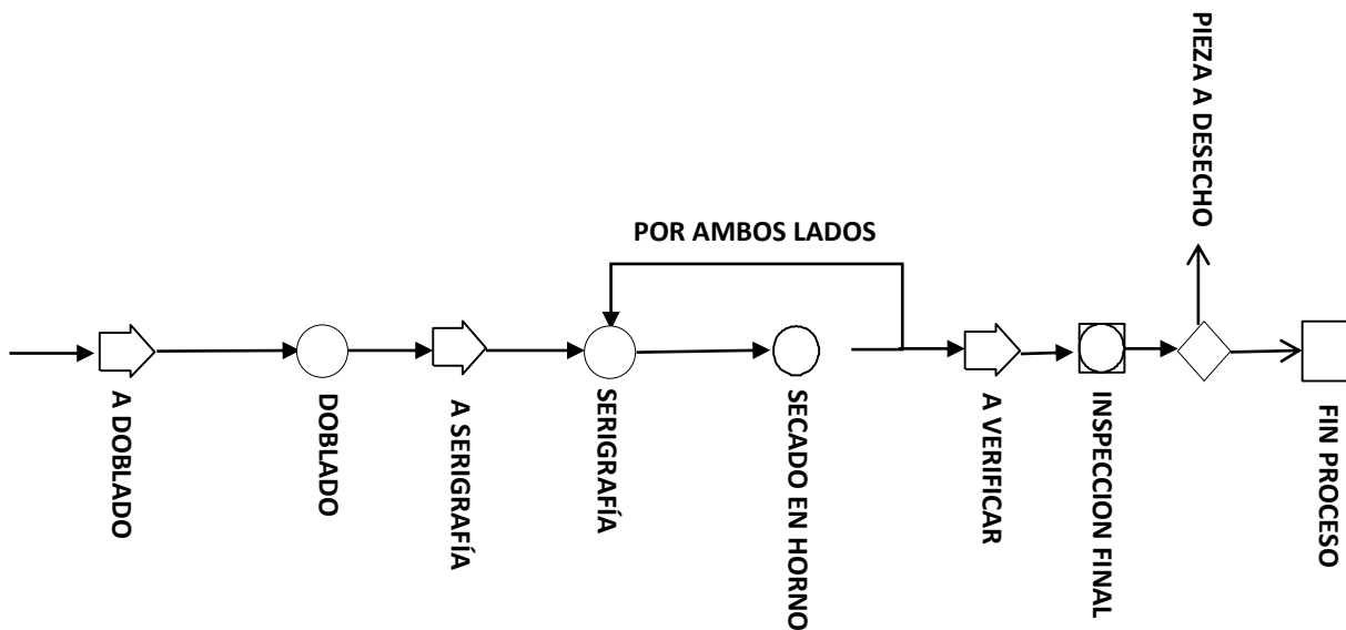
Fig. 24. Esquema del proceso de manufactura de una junta después de las mejoras
