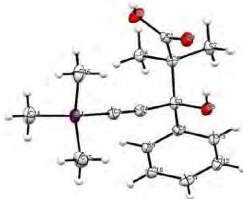
Figura 1.6: Proyección tipo ORTEP (elipsoides representados al 50% de probabilidad) del compuesto 3k .
