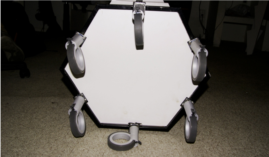
Arriba Fig. 38. Se colocaron 6 ruedas, una por cada lado de la estructura hexagonal, sin embargo por el tipo de rueda y por el poco espacio entre ellas y al estar distribuidas casi al centro de la estructura, el móvil se vuelve inestable.
