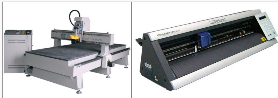
Arriba Fig. 53. Lado izquierdo: Router CNC para corte de madera. Lado derecho: Cortadora de vinil. http://popnrocks.com/wp-content/uploads/Wood-cnc-router-k60mt-china-wood-cnc-router-cnc-router.jpg http://fablabbcn.org/wp-content/uploads/2010/09/GX24-04-500x5002.jpg
