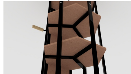
Arriba Fig. 26.1. Vista inferior de los soportes para repisas interiores. El método de fijación es con pegamento de contacto. Las repisas son de MDF de 9mm (3/8").
