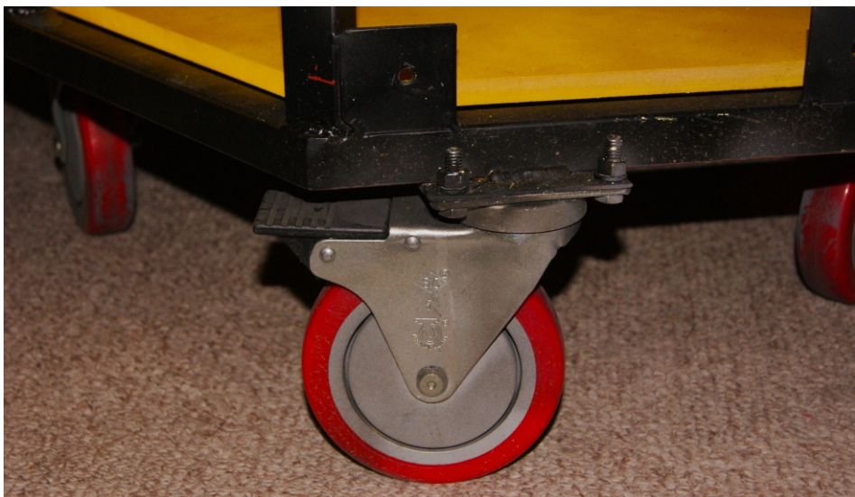
Arriba Fig. 34. Las ruedas conforman la base de apoyo, al estar muy juntas entre si generan inestabilidad, además de que su capacidad de carga en conjunto es de 2250kg, cuando el móvil sólo puede llegar a pesar 280 kg como máximo.
