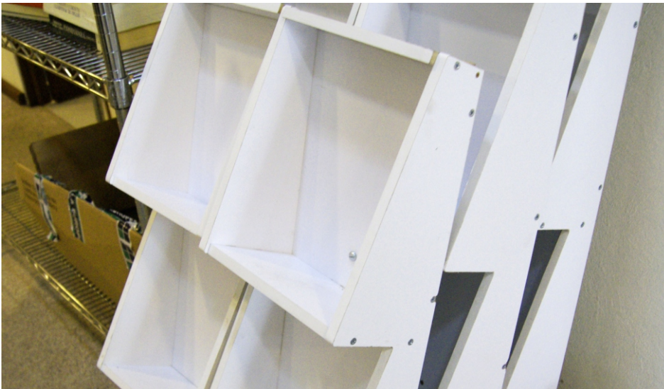
Arriba Fig. 39. La reducción de módulos es una de las principales ventajas de este prototipo, además de que se redujo la distancia entre las repisas, generando así módulos más pequeños y más adecuados para los libros.
