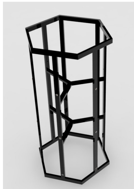
Arriba Fig. 37.2. Estructura de tubo de 25mm por 12mm con tuercas remachables para fijación de los módulos.
