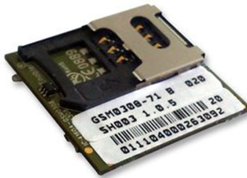
Figura 3.7. Modem ENFORA GSM0308.
