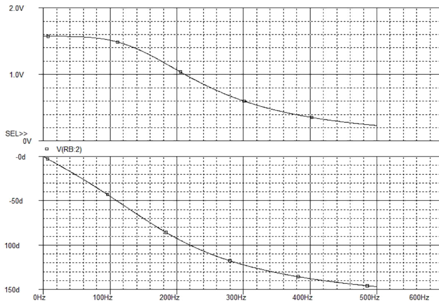
Figura A.4. Simulación Filtro paso bajas Bessel a 250[Hz].
