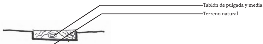
Detalle constructivo 12. Madera en terreno natural
