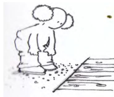
Esquema 46: El cambio de material en el pavimento de los senderos debe ser evidente y fácil de reconocer.
