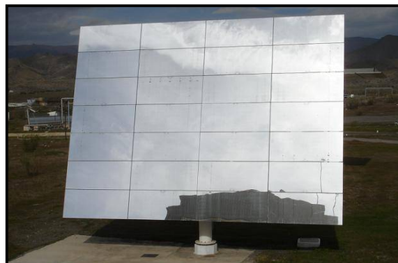
Figura II.34. Colector de concentración (heliostatos).
