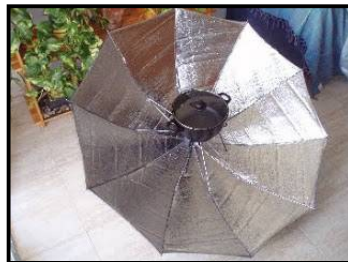
Figura III.82. Materiales reciclados para construir una estufa solar.
