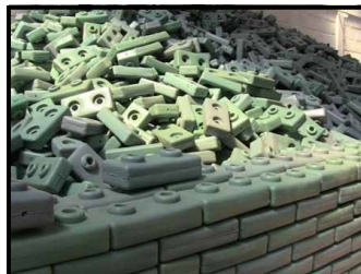
Figura II.23. Tabiques fabricados con PET reciclado.
