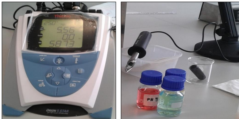
Figura 18. Potenciómetro marca Orión Modelo Five Star junto con electrodo de punción y soluciones Buffer de calibración
