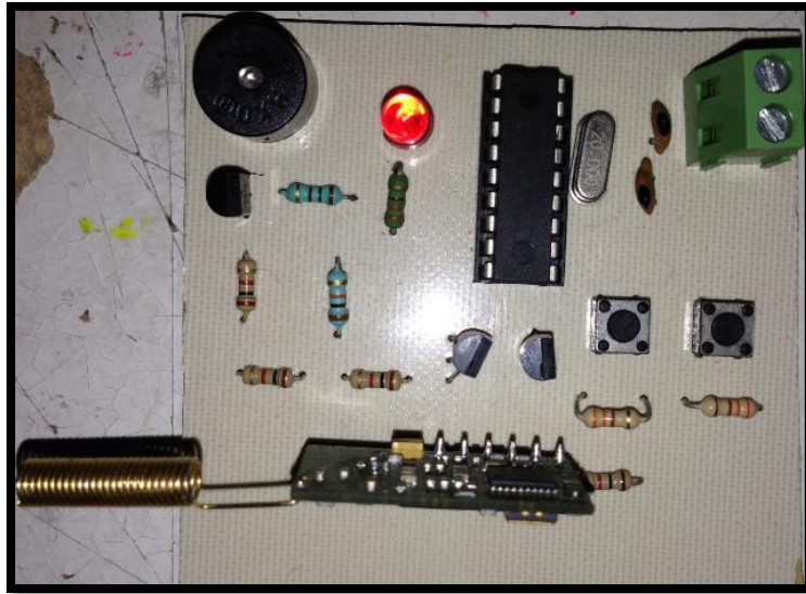
Figura 4.3. Tarjeta de componentes del Circuito Maestro.
