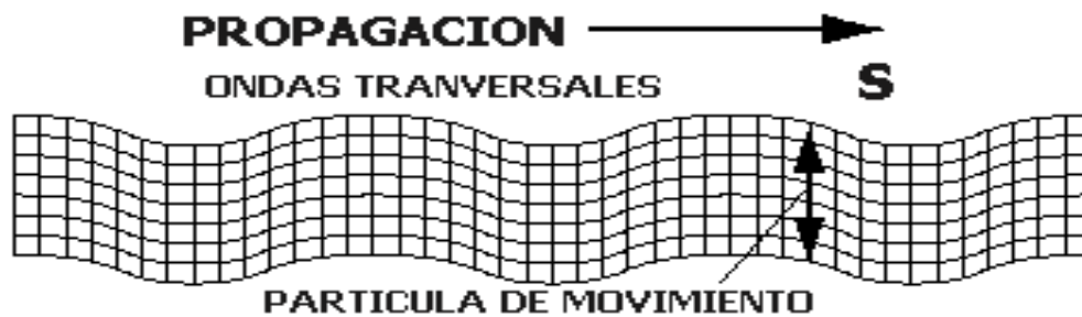
Fig. 4.5 Propagación de ondas S.
