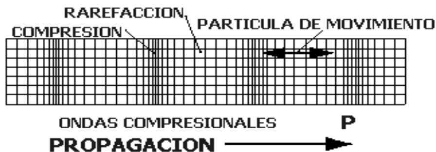
Fig. 4.4 Propagación de ondas P
