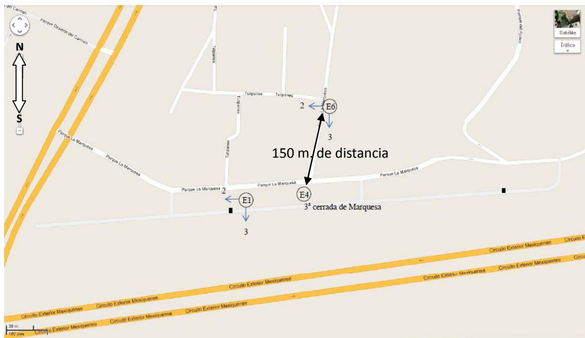
Fig. 5.7 Croquis de localización de equipos correspondiente al arreglo No. 2 realizado durante la quinta campaña de mediciones en la 3ª cerrada de la marquessa (19/01/2013).
