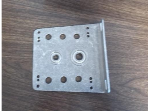
Figura A.1. Mini placa del eje con los baleros de pestaña de 1/2 y 3/8.
