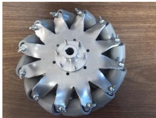
Figura 3.12. Rueda omnidireccionales de 8 pulgadas.
