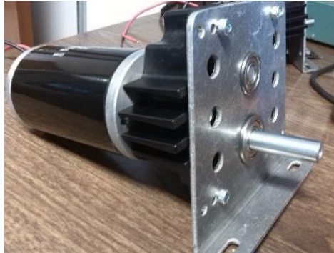
Figura 3.11. Juegos de engranes ( Toughbox Mini ) y motor.
