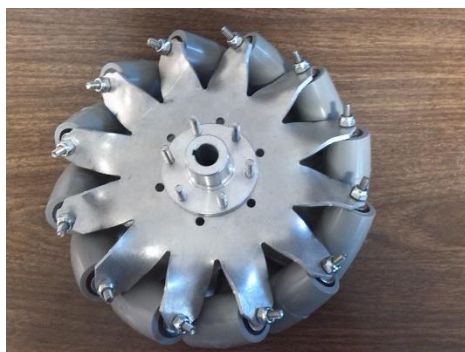
Figura A.19. Colocación de Buje de conexión a la rueda.
