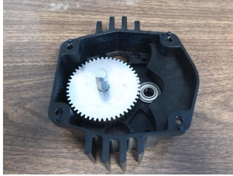
Figura A.4. La Mini tapa del Toughbox Mini con el engrane de 50 dientes colocado en la pequeña barra del eje hexagonal.
