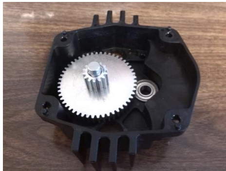
Figura A.5. Pequeño engrane de 14 dientes puesto en la pequeña barra del eje hexagonal y sobre el engrane de 50 dientes.
