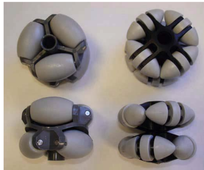
Figura 2.6. Mecanum Wheels , tipos de diseño con rodillos a 90^\circ [22].
