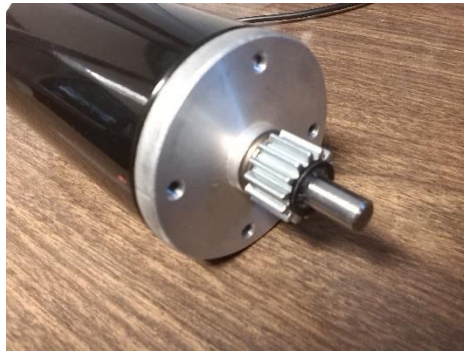
Figura A.12. Motor con engrane CIM y clip retenedor.
