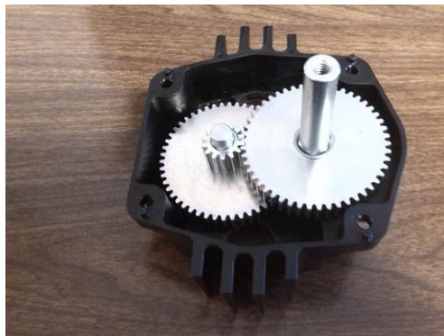
Figura A.8. Engrane de salida puesto en el reto del conjunto de juego de engranes.
