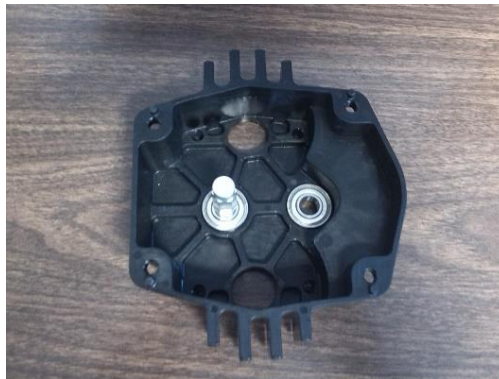
Figura A.3. La Mini tapa del Toughbox Mini con la pequeña barra del eje hexagonal colocado en el balero.
