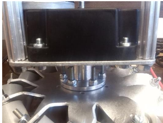
Figura A.29. Tubos hexagonales en la parte inferior del Toughbox Mini .
