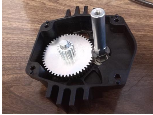
Figura A.7. Mini tapa Toughbox Mini con eje hexagonal de salida.
