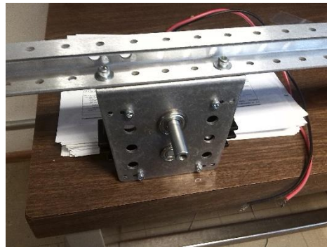
Figura A.26. Conexión del Toughbox Mini y la canaleta para la plataforma.
