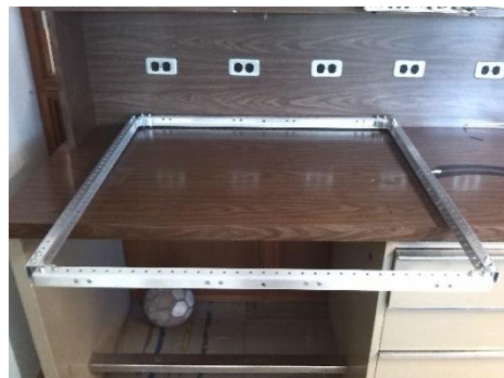
Figura A.25. Cuadro externo de la plataforma.
