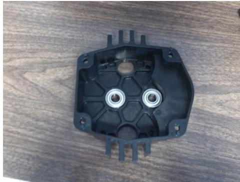
Figura A.2. La Mini tapa del Toughbox Mini con los baleros de 1/2.
